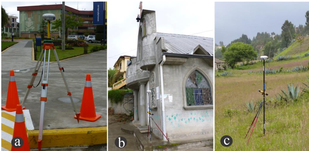
Figura 30. Equipo DGPS y tipo de mojón utilizado: a) Receptor fijo o “estación base” b y c) Receptor móvil o “rovers”
