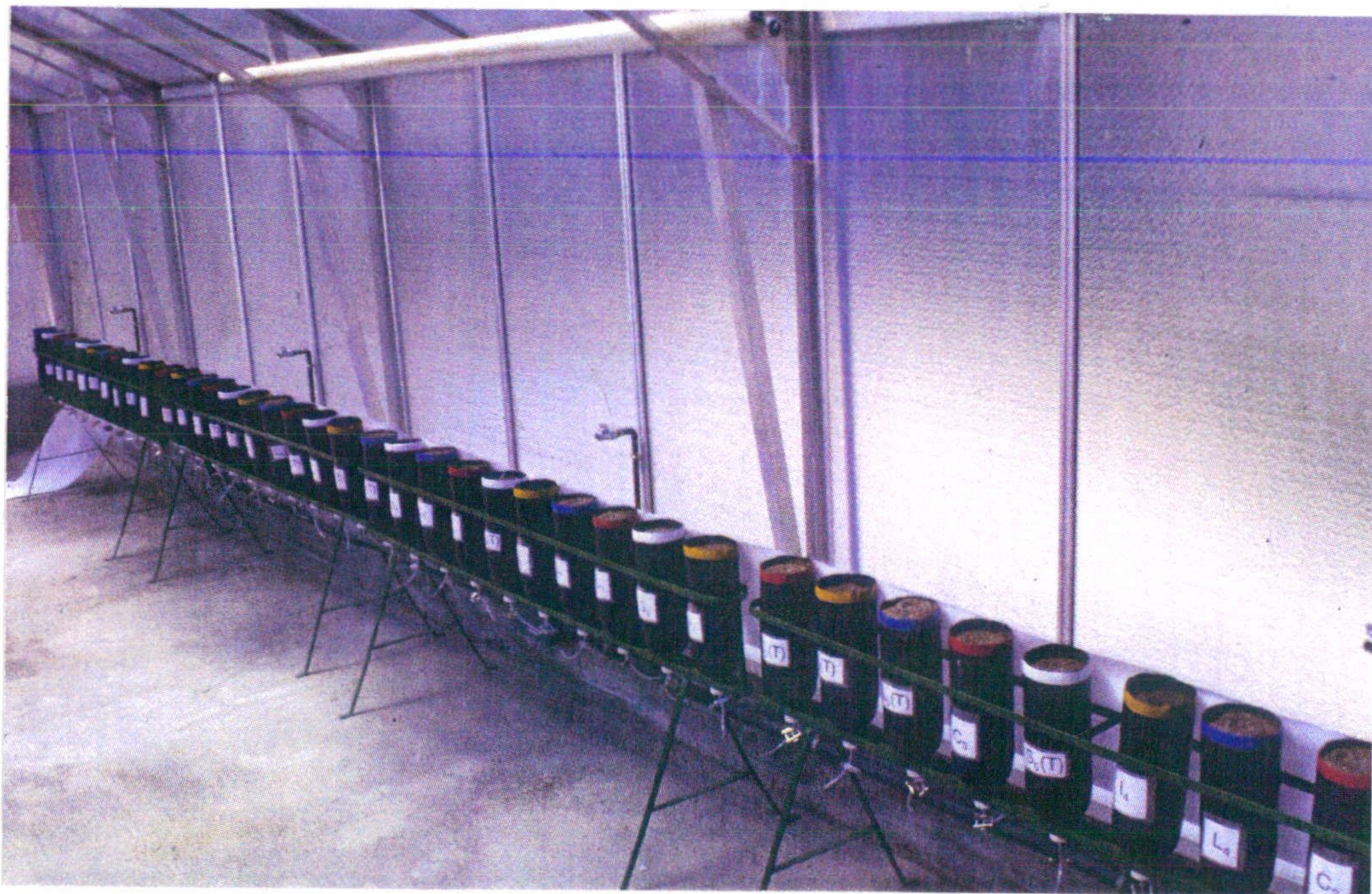
Foto 4. Disposición de las columnas lisimétricas en el invernadero.
