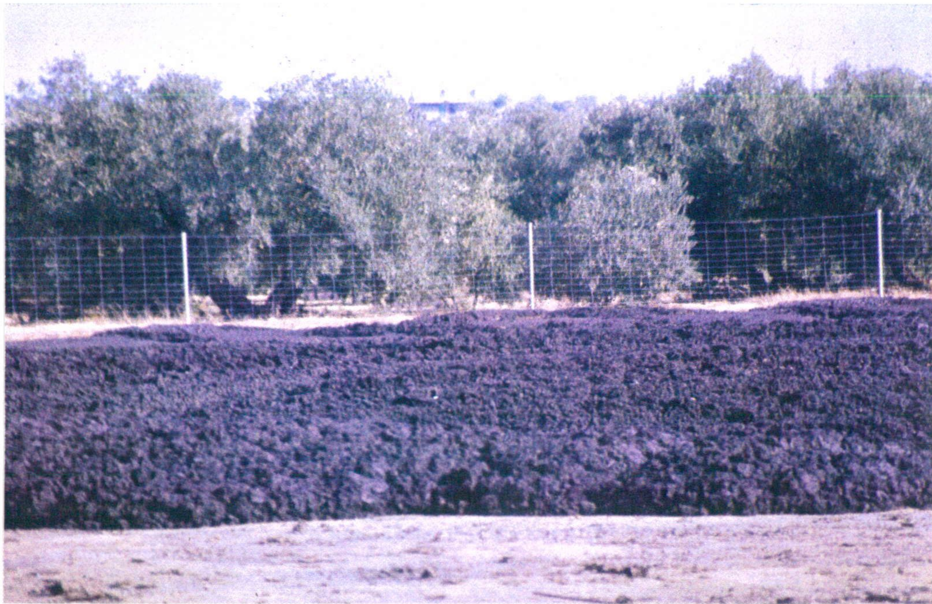
Foto 1. Planta de compostaje. Era de secado de los lodos deshidratados procedentes de las EDAR de Granada.
