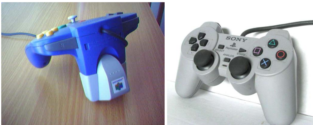
Img. C III.11.: Mando de Nintendo 64 con el accesorio Rumble Pak acoplado (de color gris, abajo, salido al mercado en 1997). Derecha: Mando DualShock para PlayStation, que perseguía sustituir el control original de dicha consola (1997). Este controlador incorporaba de fábrica dos motores de vibración sin necesidad de accesorios extra.
