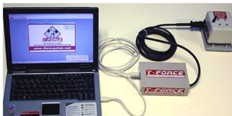
Figura 27. Dispositivo de desplazamiento lineal utilizado (T-Force System, Ergotech).
