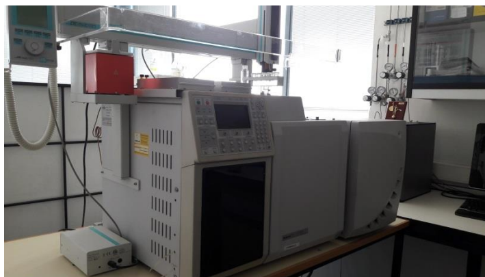
Figura 1.4. Equipo de cromatografía de gases acoplado a un espectrómetro de masas con analizador de trampa de iones, usado para el análisis de las muestras.
