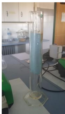
Figura 18. Biorreactor empleado en el ensayo X. Flujo vertical.
