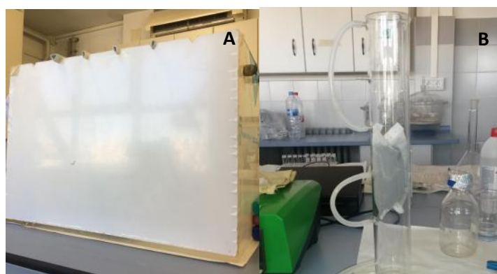
Figura 15. Biorreactores empleados en el ensayo VII. Flujo horizontal (A) y vertical (B).
