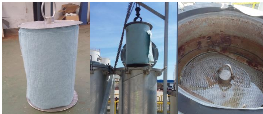
Figura 23. Material absorbente empleado. Planta Piloto en instalaciones de CLH en Motril (Granada).
