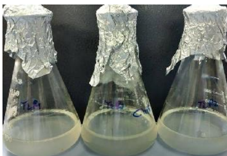
Figura 20. Matraces con medio BH empleados para la búsqueda de microorganismos degradadores de hidrocarburos.
