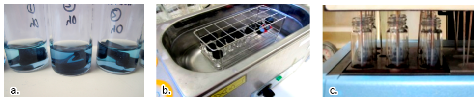
Figura 2.4: Extracción del colorante de las muestras de papel para su análisis por EC-DAD.
