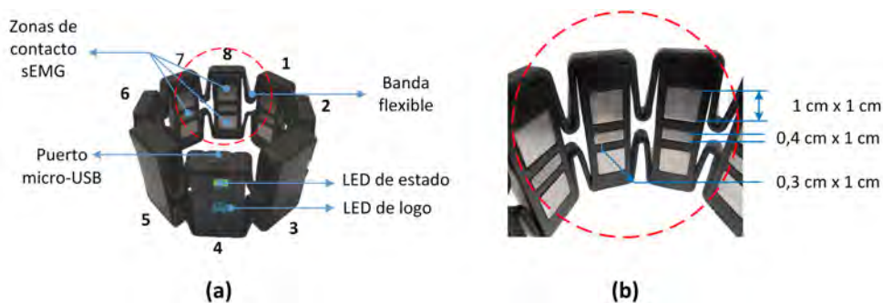
Figura 3.6: Pulsera gestual MYO y componentes externos. (a) Distribución de sensores. (b) Dimensiones de los sensores sEMG.
