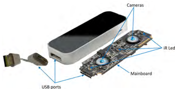
Figura 2.3: Leap Motion y sus componentes
