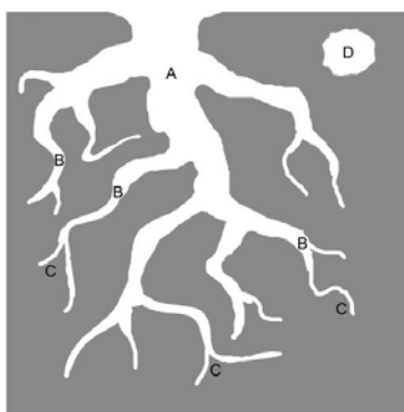
Figura 10. Representación esquemática de la porosidad de un carbón activado. A: macroporos, B: mesoporos, C: microporos y D: poros cerrados
