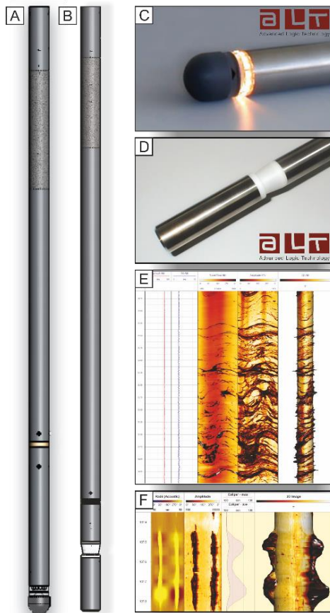
Fig. 2.8. (A) Optical Televiewer. (B) Acoustic Televiewer. (C) Detalle de la zona de grabación de la sonda óptica. (D) Detalle del sensor acústico. (E) Ejemplo de registro obtenido con este tipo de sondas. (F) detalle del registro acústico, que muestra la morfología de las paredes del sondeo.
