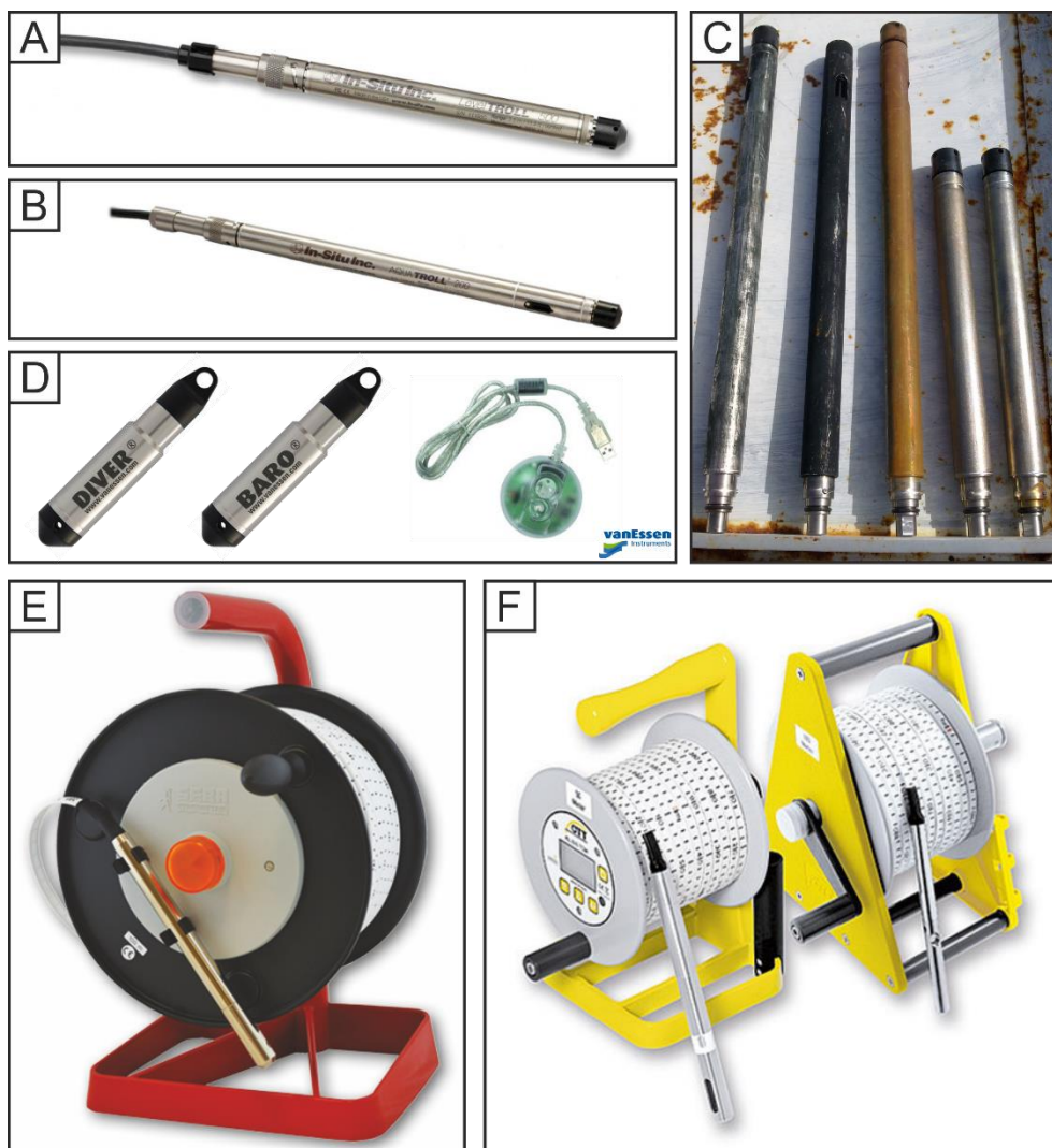
Fig. 2.2. Conjunto de aparatos utilizados en campo. (A) Sonda LevelTROLL®-500. (B) Sonda AquaTROLL®-200. (C) Sondas AquaTROLL® y LevelTROLL® instaladas en el sondeo surgente PB, a diferentes niveles. (D) Sondas DIVER® y conector. (E) Sonda electrónica de nivel KLL. (F) Sondas electrónicas de nivel KL 010.
