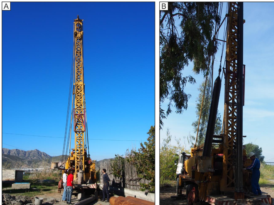
Fig. 2.6. (A) Máquina de perforación a percusión emplazada sobre el punto a perforar. (B) Detalle del trépano de percusión durante el trabajo de perforación.
