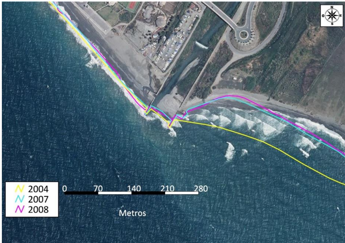
FIGURA 19. Evolución de la línea de costa entre 2004 y 2008 en el tramo 2
