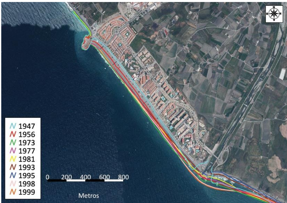
FIGURA 11. Evolución de la línea de costa entre 1947 y 1999 en el tramo de la Playa de Salobreña
