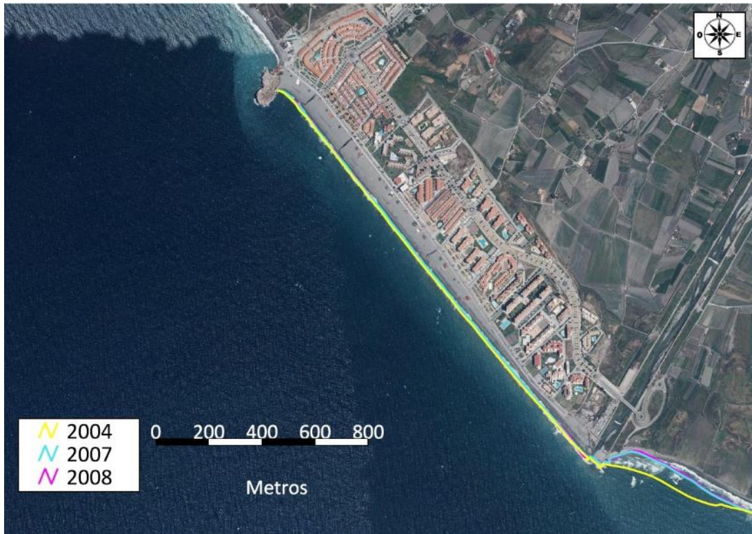
FIGURA 15. Evolución de la línea de costa entre 2004 y 2008 en el tramo 1
