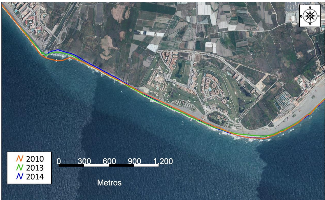
FIGURA 25. Evolución de la línea de costa entre 2010 y 2014 en el tramo 3
