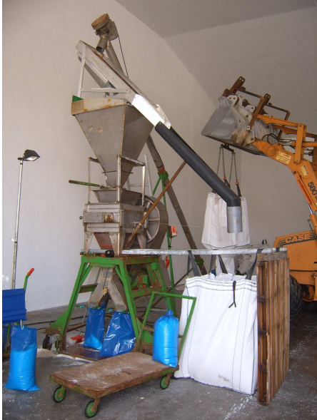
Foto. En primer plano se observa la turba que muele la sal, que cae directamente en sacos de plástico de 25 kg. Detrás, una pala excavadora.
