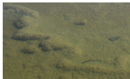
Foto. Detalle de los sulfatos depositados en el fondo de la alberca
