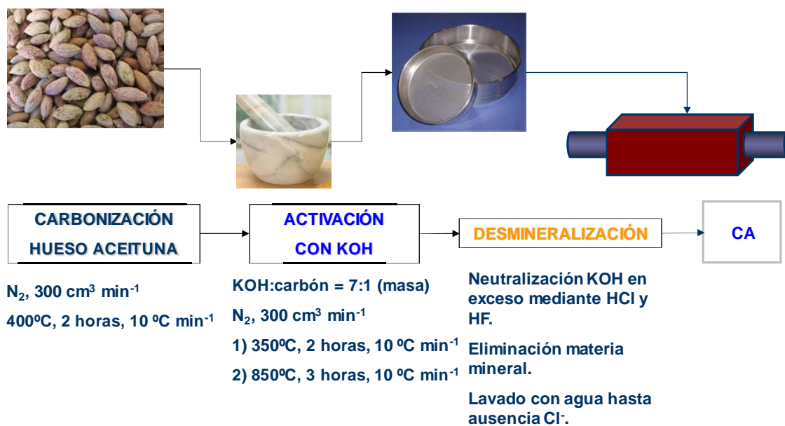
Figura 2.1. Síntesis de la muestra CA obtenida por activación química de hueso de aceituna.
