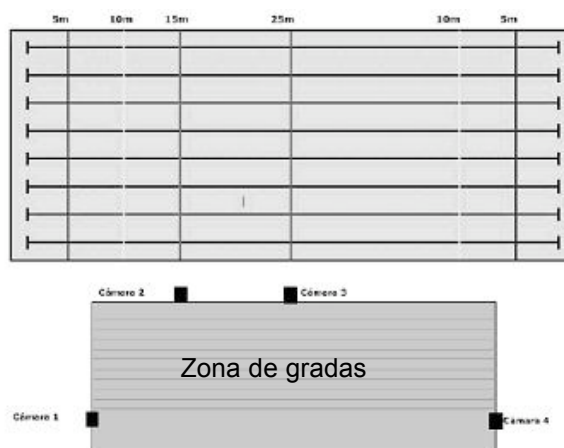
Figura 1: Representación gráfica de la colocación de las cámaras y de las referencias tomadas en la piscina de competición para el posterior análisis de resultados.
