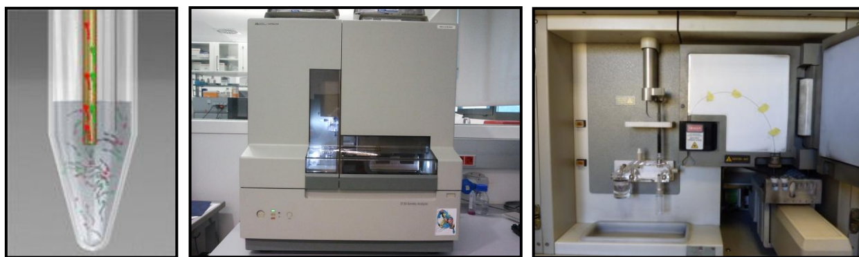
Figura II.1: El ADN se introduce dentro del capilar por donde migra. Equipos de electroforesis capilar donde se han llevado a cabo los análisis, ABI Prism 3130 ( centro ) y ABI Prism 310 ( derecha )
