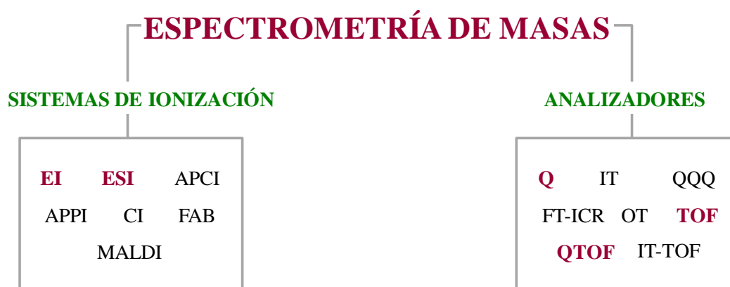
Figura 34. Sistemas de ionización y analizadores de masas más utilizados (■ Utilizados en la realización de la tesis)
