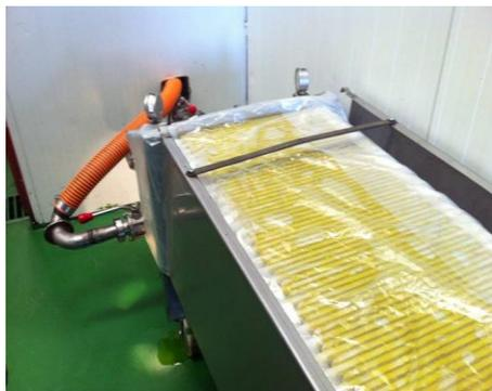
**Figura 9.1. Filtración del aceite de oliva.**
