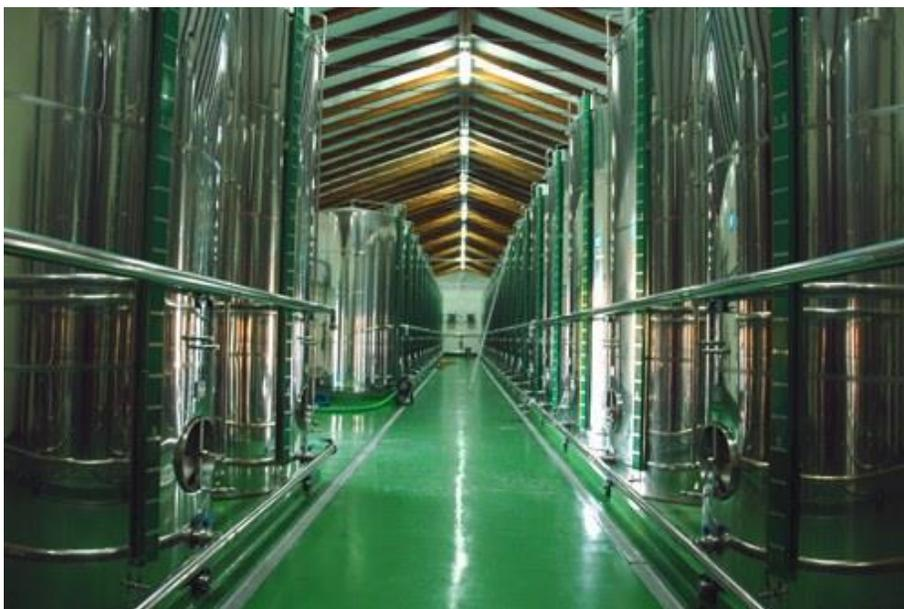
**Figura 8.1. Almacenamiento de aceite de oliva en depósitos de acero inoxidable.**
