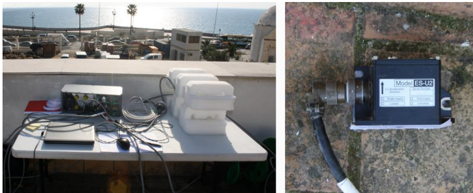
Figura 10. Central de Adquisición de datos, equipo informático y acelerómetro de fuerza balanceada.
