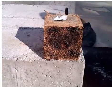
Figura 4. Estado final de la muestra de la familia 2 tras el ensayo con soplete.
