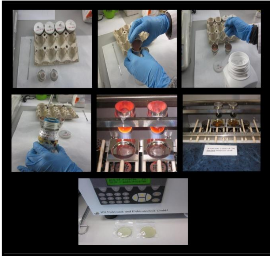
Figura 3.18 – Secuencia de preparación para perla
