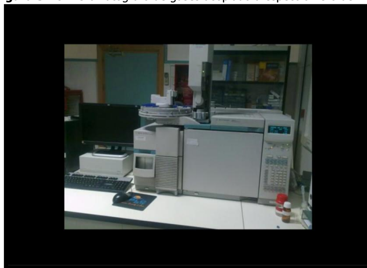
Figura 3.26 – Cromatógrafo de gases acoplado a espectrómetro de masas 45 .
