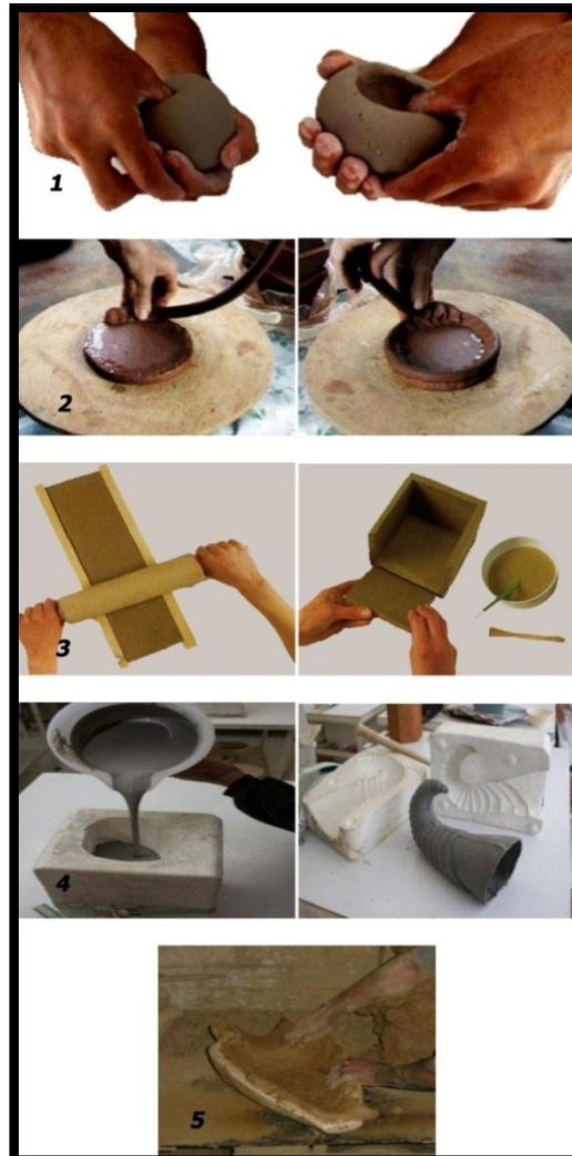
1. Presión manual; 2. Rollos; 3. Tablillas; 4. Moldes vaciados; 5. Moldes a presión.
