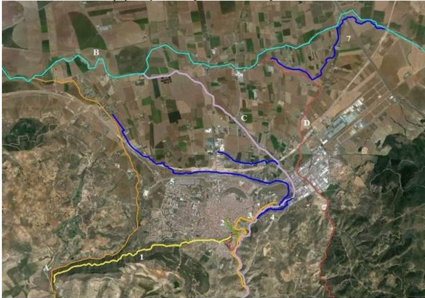
A. Arroyo del Alcázar; B. Río del Guadalhorce; C. Río de la Villa; D. Arroyo de las Adefas. 1. Arcas de la ciudad; 2. Arcas de S. Francisco; 3. Cauz antiguo; 4. Acequia de los Remedios; 5. Acequia Alta; 6. Acequia de Enmedio; 7. Acequia Jardín o del Partido Alto.
