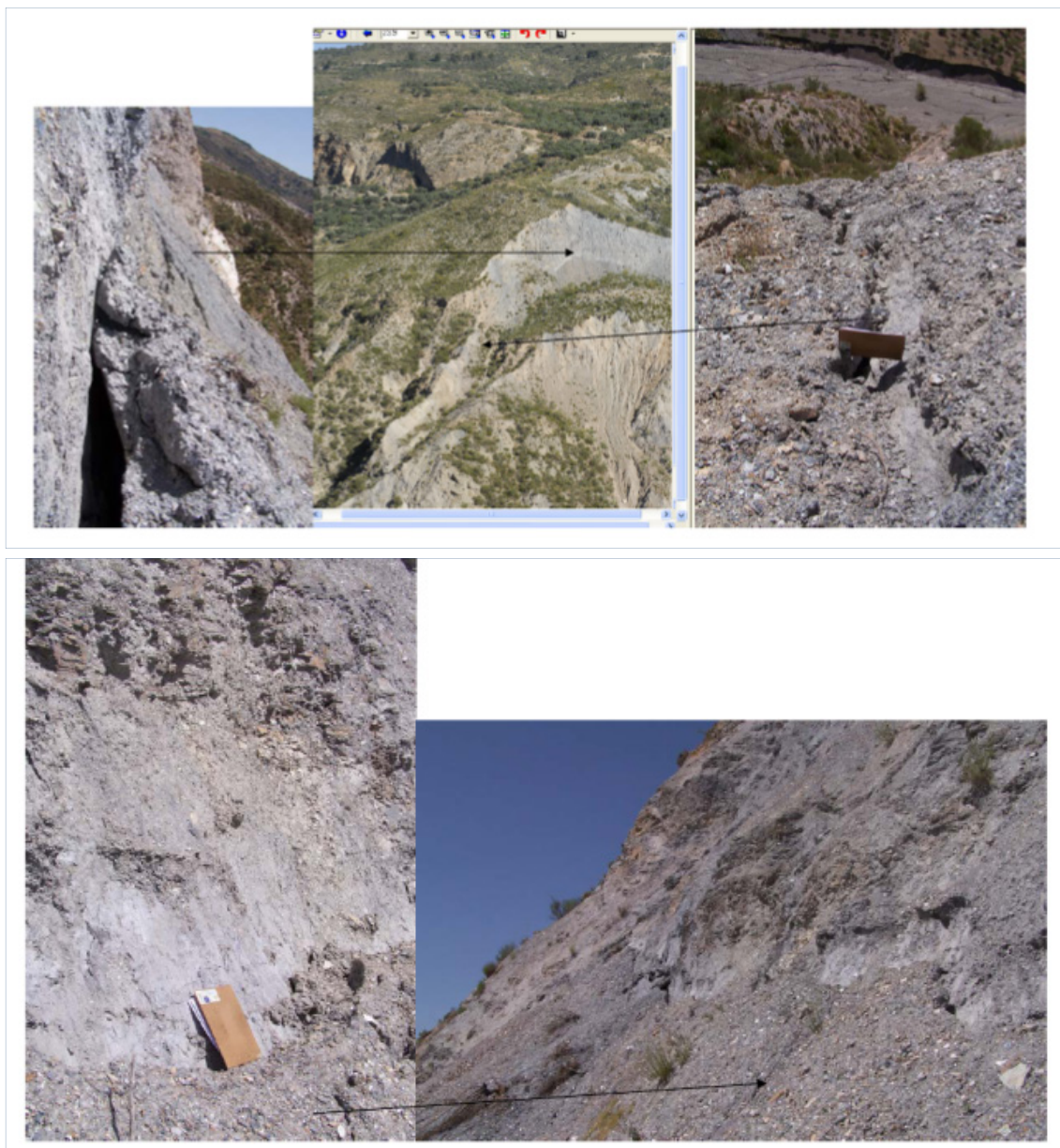
Figura 62 Fotografías del escarpe principal y flanco suroeste del deslizamiento de Almegijar, tomadas durante el control de campo realizado en la fecha de 16/07/2010 tras la obtención de los resultados en gabinete. Se observan grietas recientes con poco relleno y limpias de casi 50 cm de apertura, así como un escarpe planar, también limpio y sin alteración superficial, con un salto máximo aproximado de 1.50 m
