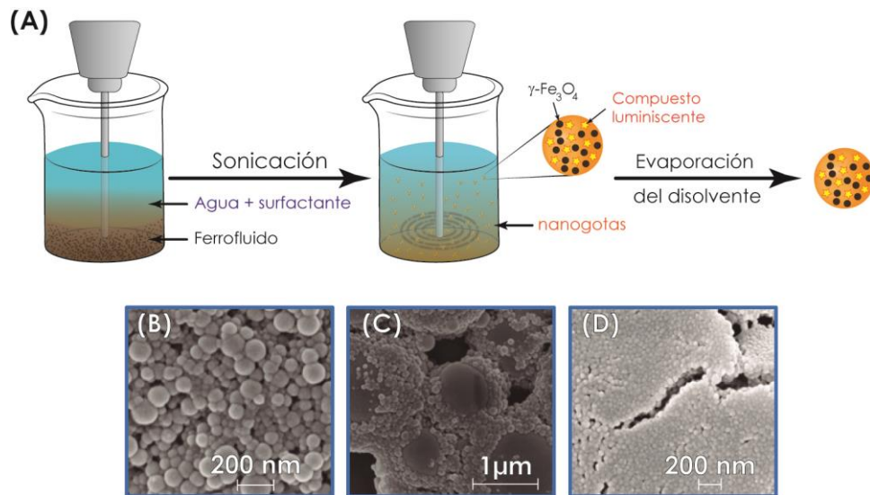
Figura 11. (A) Esquema de preparación de nanopartículas híbridas por miniemulsión-evaporación y fotografías SEM (B, C y D) de nanofases sensoras magnéticas preparadas por esta metodología.
