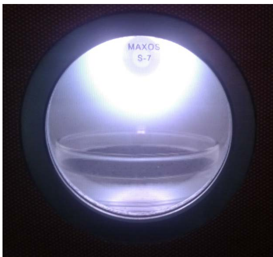
Figura 1.29. Aspecto de la cámara de trabajo de un equipo generador de plasma durante la formación de un plasma de microondas para el tratamiento de CNTs. La fuente de microondas puede observarse al fondo de la cámara rodeada de un halo luminoso.
