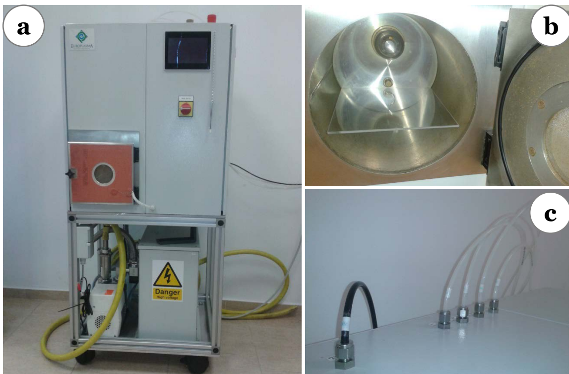
Figura 2.1. Imágenes del equipo comercial usado para la generación de NTPs de microondas: (a) vista frontal, (b) interior de la cámara de trabajo cilíndrica con la fuente de microondas en la pared posterior y (c) conducciones para la entrada de gases en el equipo.
