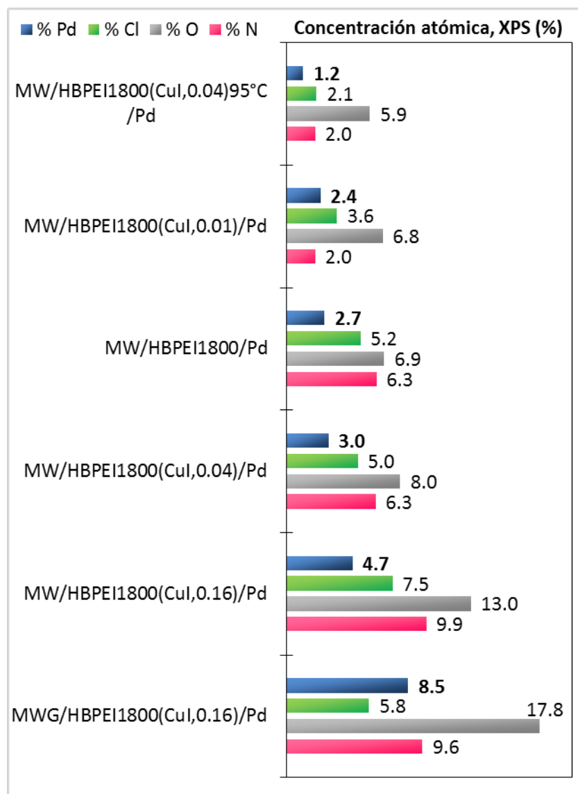
Figura 5.4. Composición química superficial (XPS) de los seis materiales empleados en la captura de iones Pd 2+ .
