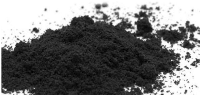
Figura 3.1. Apariencia del material comercial Thin MWCNTs 3100 de Nanocyl™ (Muestra MW).
