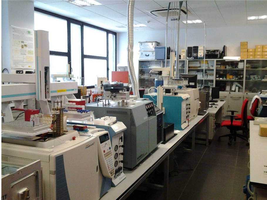
Fig.4.10. Laboratorio de Biogeoquímica de isótopos estables I: analizador elemental (Carlo Erba Modelo NA1500 NC serie 2) (Foto Z. Laffranchi).
