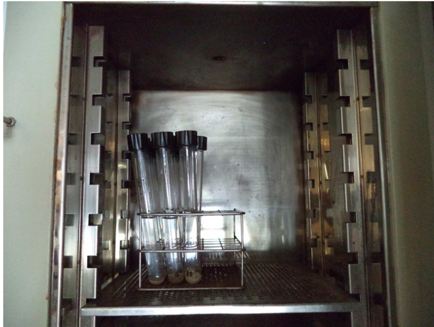
Fig.4.8. Solubilización del colágeno: tratamiento con 0,010 M HCl a 100° durante 17 horas en tubos cerrados de pirex (Foto Z. Laffranchi).
