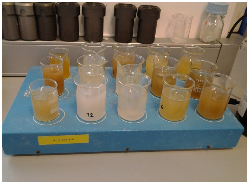
Fig.4.5. Tratamiento con 100 ml HCl 1M en el agitador magnético (Multi 15 Stirrer) (Foto Z. Laffranchi).
