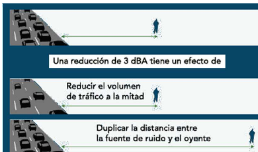
Figura 5.7: Representación del efecto de los pavimentos silenciosos sobre el ruido. Fuente: [COPV, 2012]
