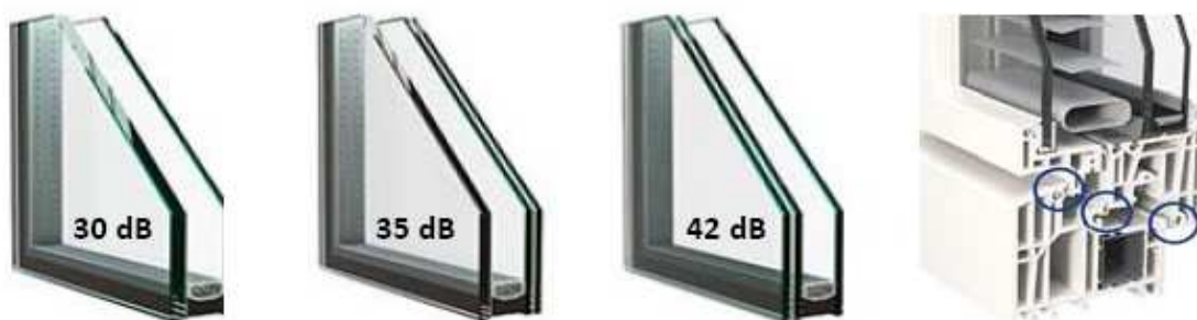
Figura 6.29: Tipos de ventanas para aislamiento acústico según datos de RA tr. Fuente: [Jiménez Díaz et al., 2014].
