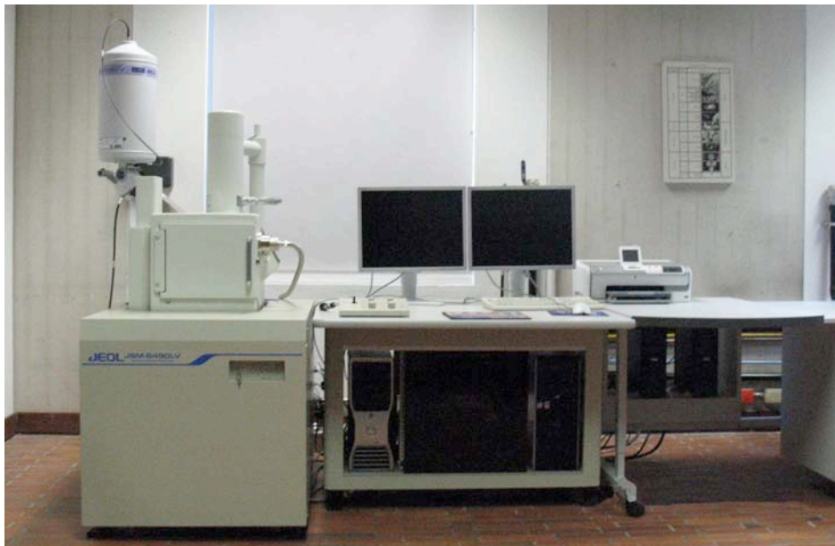
Figura 3: Microscopio electrónico de barrido JEOL JSM-6490LV
