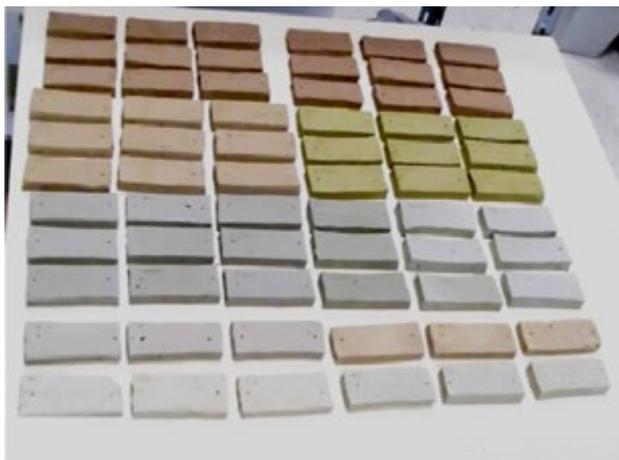
*FOTO 3: Fuente: Lucía Rueda Quero; Nota pie de imagen: Foto 3: Relación de probetas obtenidas de diferentes yacimientos en proceso de secado previo a la cocción, todas con iguales condiciones de fabricación para favorecer la fiabilidad de los resultados.*
