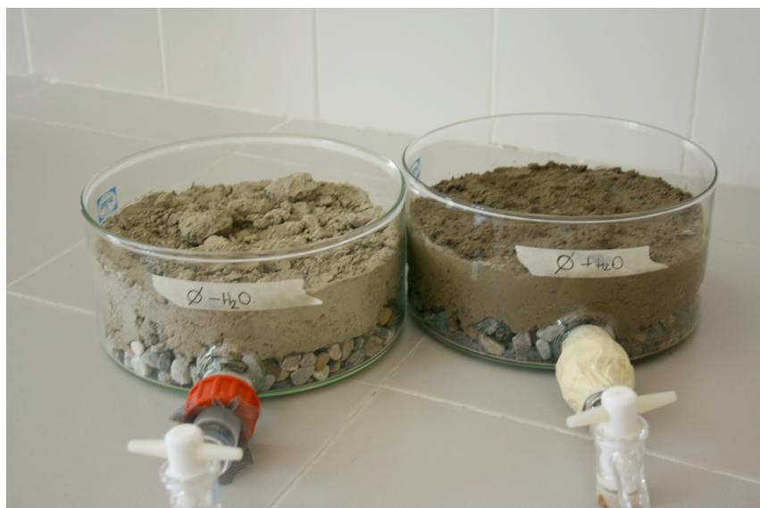
**Figura III.6. Microcosmos edáficos compuestos por un suelo franco-arenoso.** A la izquierda se muestra un microcosmos sometido a condiciones de sequía y a la derecha un microcosmos en condiciones de humedad.
