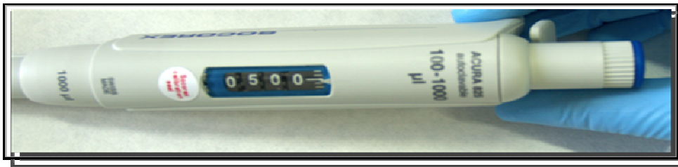
Figura IV. 14. Pipeta empleada en el estudio (Sorderex, modelo Acura 825)
