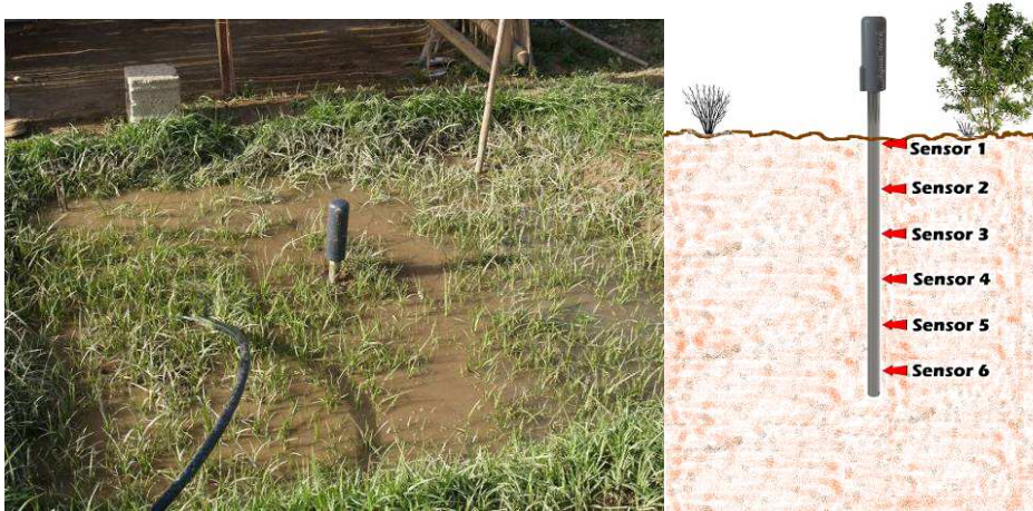
Figura 8.4. Vista general de la sonda Aquacheck en la subparcela experimental
