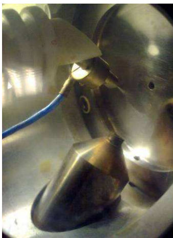
Figura 3.20. Detalle del interior de la interfase ESI utilizada, formación del spray
