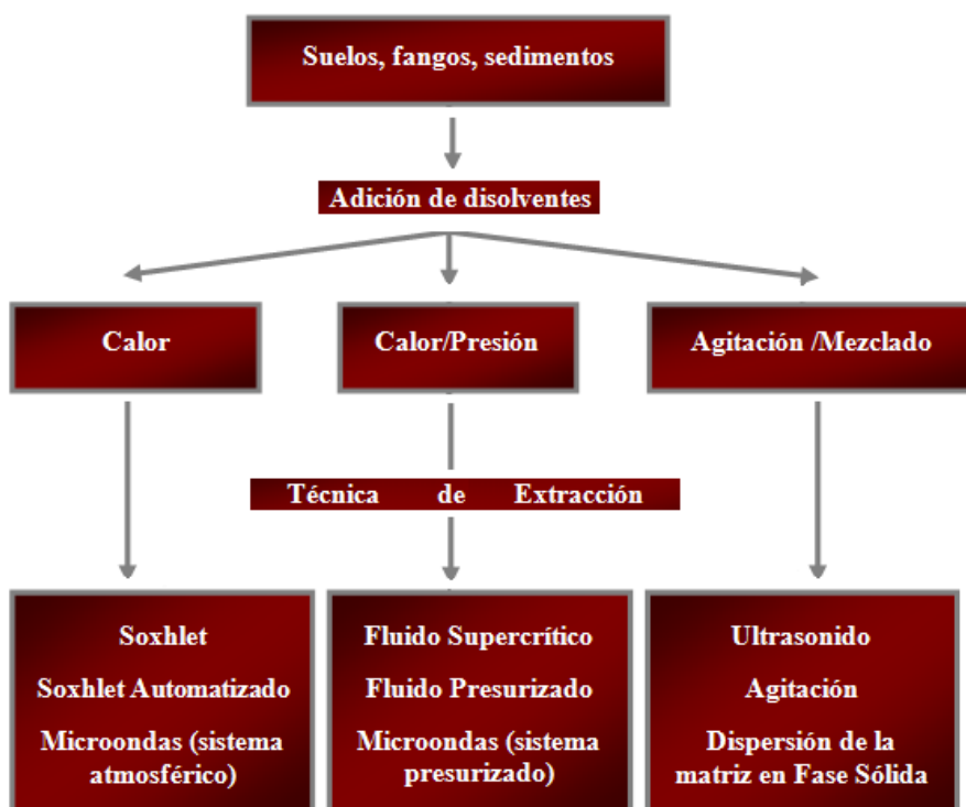
Figura 4.1. Diagrama de las técnicas de extracción para matrices sólidas
