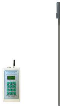
Figura 8.3. Registrador de datos inalámbrico AquaCheck Hand-held RF Logger (izquierda); Sonda AquaCheck II probe (derecha)
