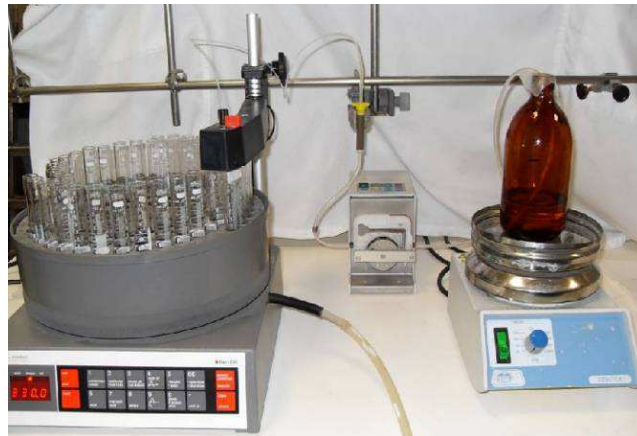
Figura 7.26. Montaje utilizado para la realización de las experiencias en continuo
