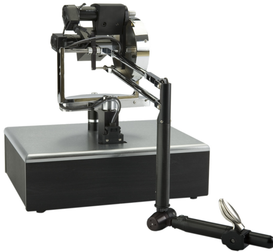
Figura 5.1 – Dispositivo háptico (foto cortesía de SensAble Technologies). El brazo robótico articulado posee un mango que permite sujetar el dispositivo y mover el puntero háptico.
