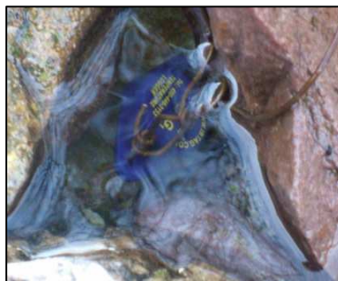
Figura 12. Medidor de temperatura en continuo situado en la orilla de un río.
