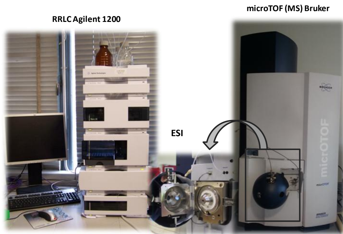
Figura 24. Equipo de cromatografía líquida de resolución rápida (RRLC) acoplado a espectrómetro de masas con analizador de tiempo de vuelo (TOF-MS) mediante ionización por electrospray (ESI).
