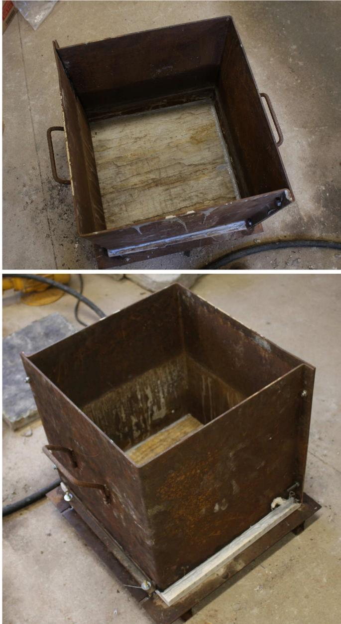
Figura 3.2.5: Encofrado montado sobre la muestra original
