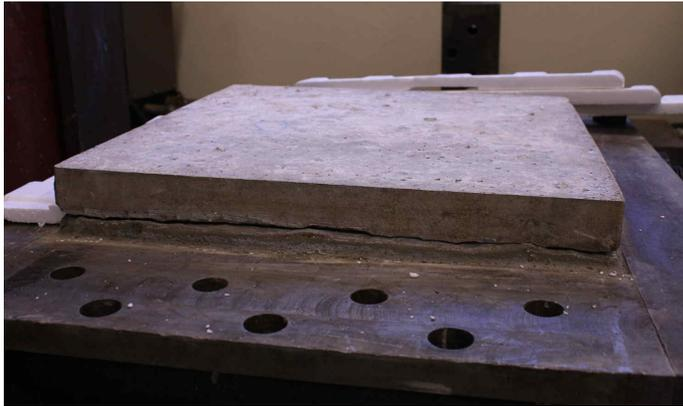
Figura 3.2.8: Una pareja de muestras montada sobre la caja inferior
