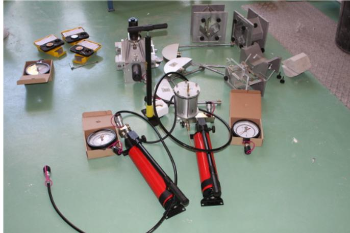
Figura 3.2.3: Dispositivos desmontados del equipo de corte
