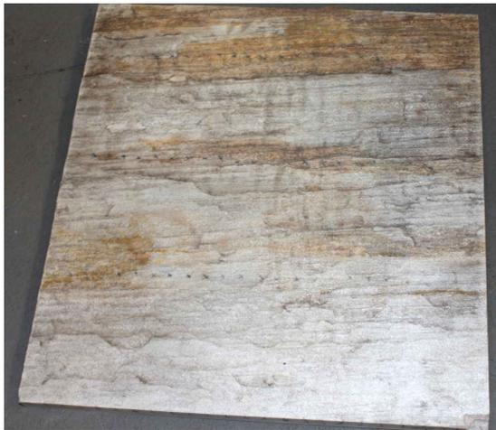
Figura 3.2.4: La muestra de cuarcita una vez cortada
