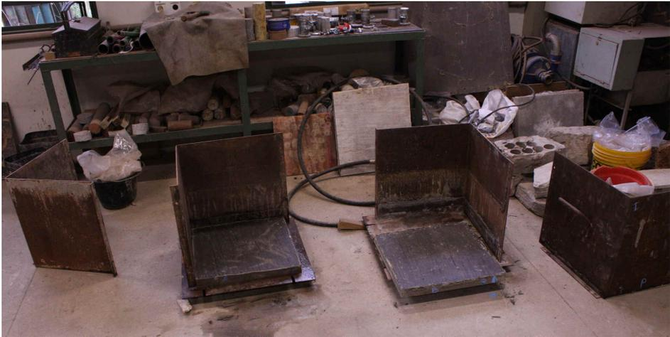
Figura 3.2.7: Las réplicas  $A_0$  y  $B_0$  que sirven de molde para las réplicas que van a ensayarse
