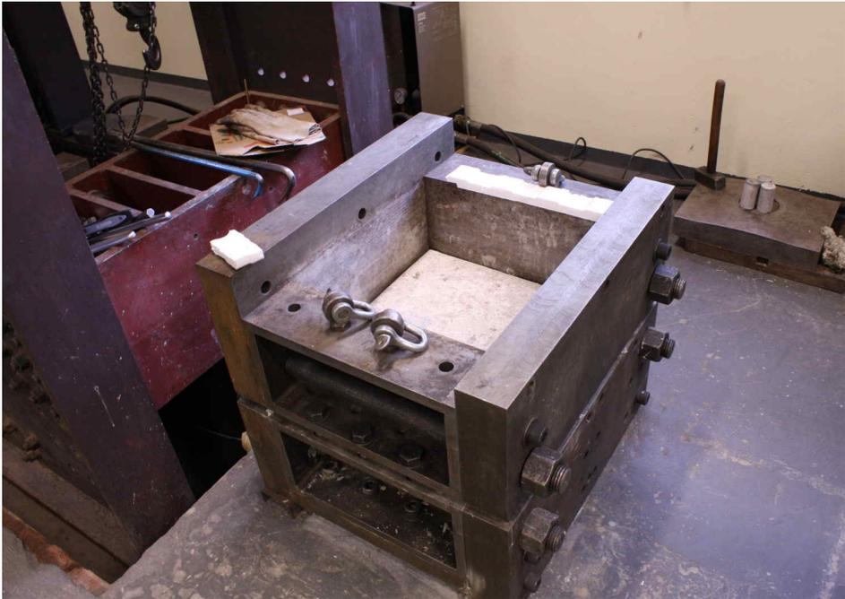
Figura 3.2.9: La caja superior de acero, sin rellenar, montada sobre la pareja de muestras
