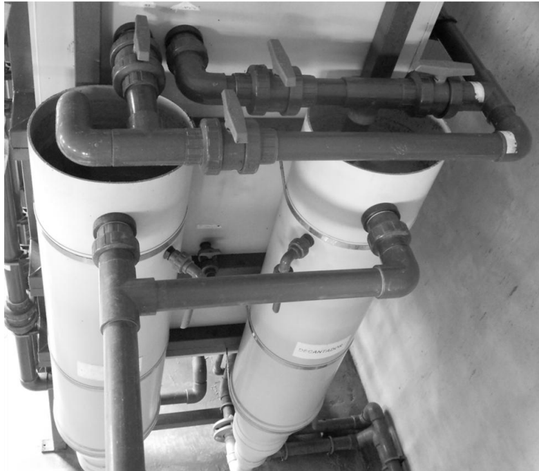
Figura 18. Detalle de la planta piloto semi-técnica utilizada durante la investigación de choque, en la que se observa el sistema de entrada y salida del decantador de la planta
