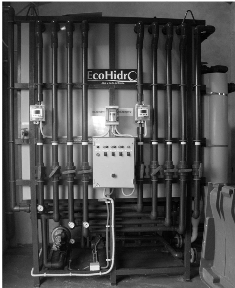
Figura 15. Fotografía de la planta piloto semi-técnica empleada en la investigación de choque con dos reactores biológicos y dos decantadores
