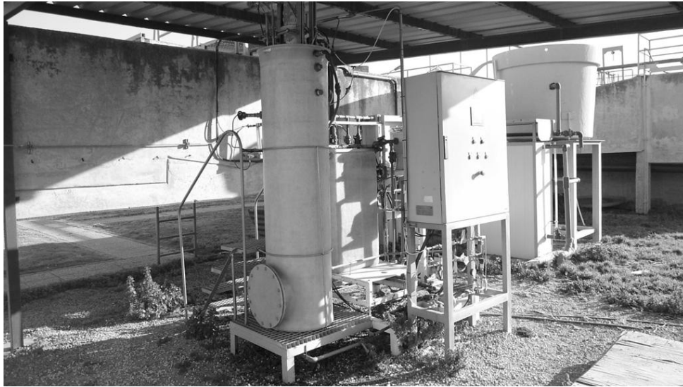
Figura 38. Instantánea de la Planta piloto experimental de biorreactor de membrana con lecho móvil utilizada durante la investigación de fondo
