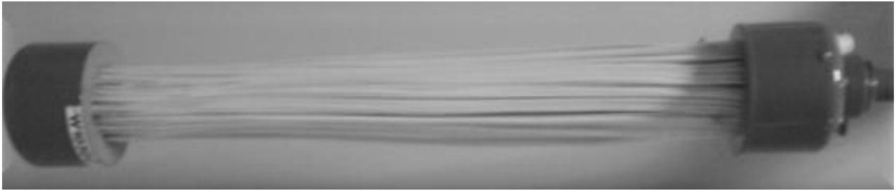
Figura 42. Modulo de membrana ZW-10 de fibra hueca empleado en la planta piloto de biorreactores de membrana con lecho móvil de la investigación de fondo
