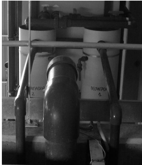
Figura 21. Vista de la salida de los decantadores tras proceder al desdoblamiento de la misma de la planta piloto semi-técnica utilizada durante la investigación de choque
