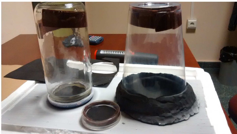
Figura 27: Detalle de los tres primeros prototipos durante las pruebas (de izquierda a derecha: tarro de cristal, placa Petri y vaso cuba-litro) colocados sobre la placa de aluminio y el hielo seco.
