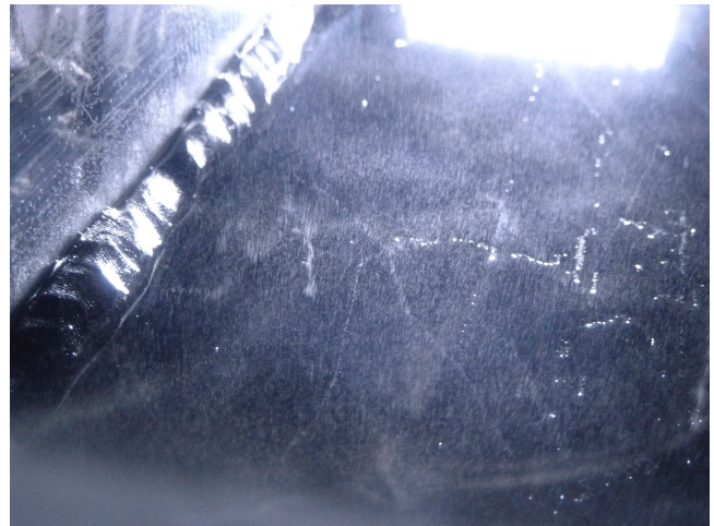
Figura 29: Izquierda: Observación de las primeras trazas con prototipo basado en pecera. Derecha: Exceso de niebla en la cámara.
