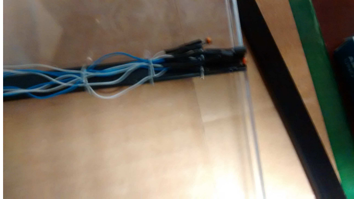
Figura 11: Termistores y cableado montados en la cámara.
