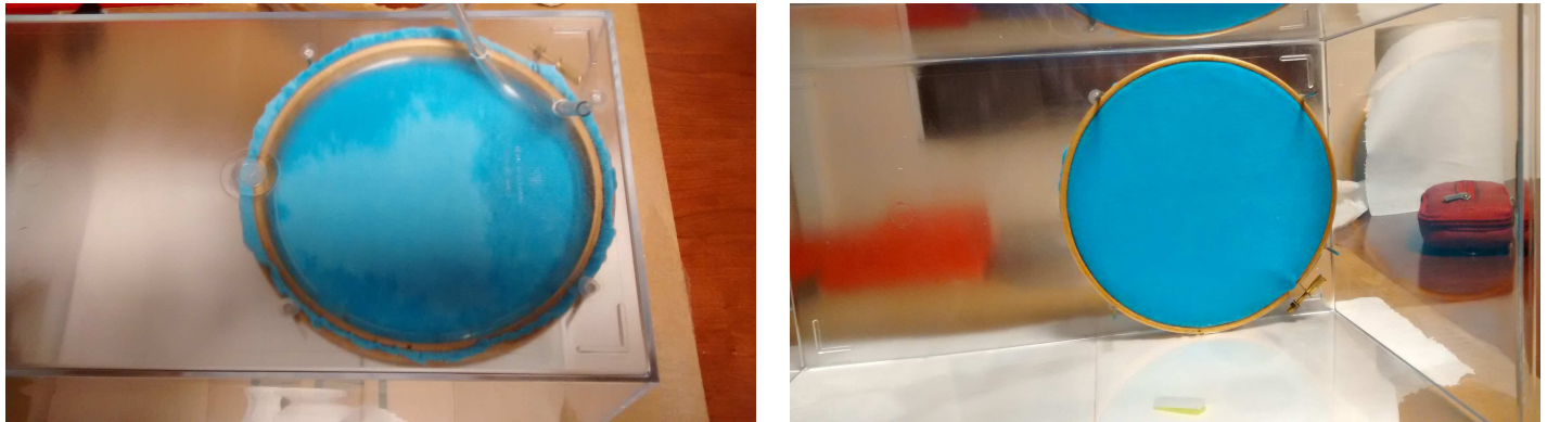
Figura 31: Izquierda: Bastidor pegado a la cámara y humedecido parcialmente. Derecha: Bastidor desde el interior de la cámara totalmente humedecido.
