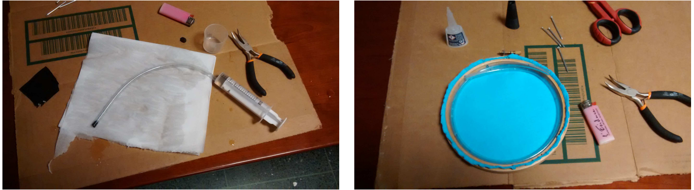
Figura 30: Izquierda: Tubo de silicona usado para la prueba sencilla. Derecha: Tubo adherido al bastidor.
