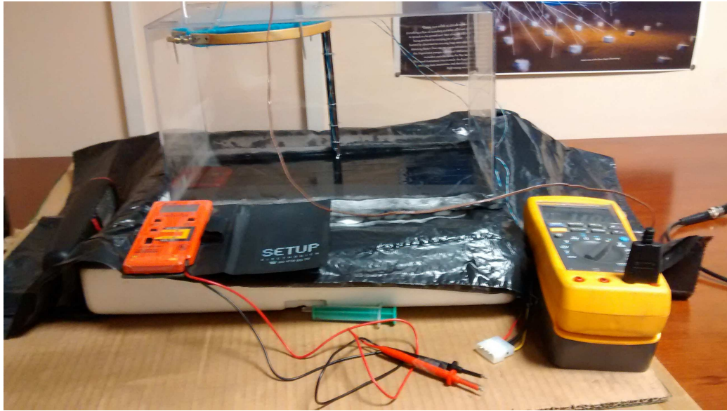
Figura 37: Cámara sobre hielo seco y polímetros durante calibrado de PT10k.
