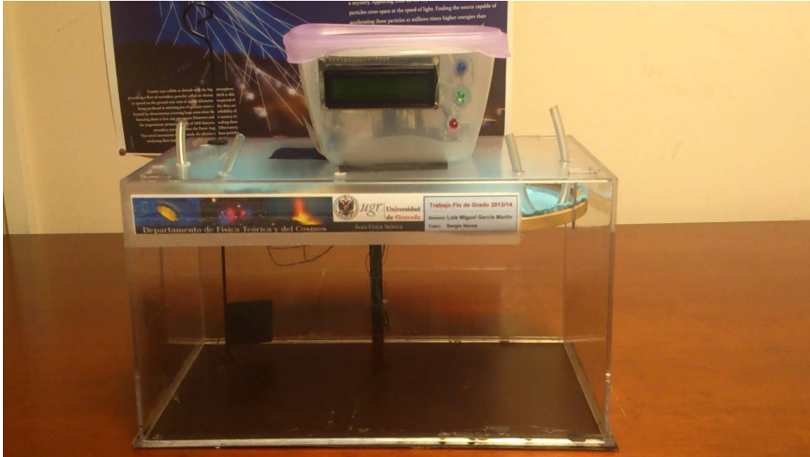
Figura 6: Versión final de la cámara de niebla elaborada en este Trabajo Fin de Grado.
