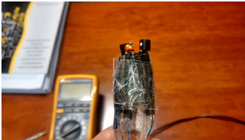
Figura 15: Termistores agrupados para el calibrado de temperatura.
