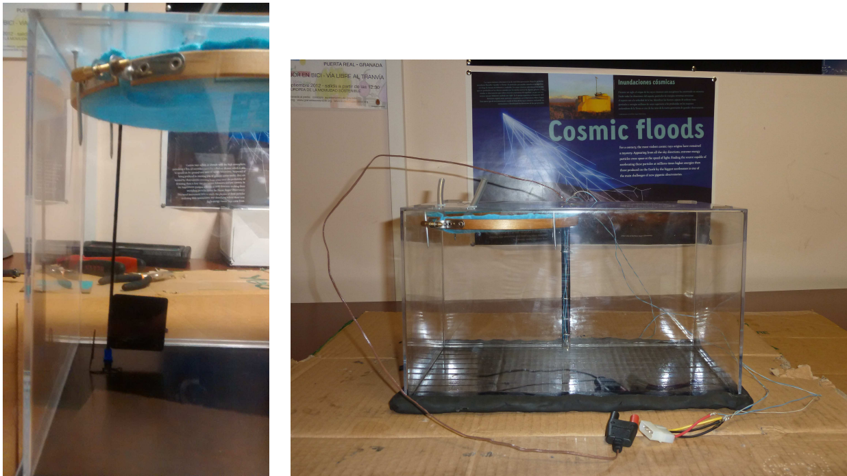
Figura 8: Izquierda: Soporte de fuente radiactiva y compuerta. Derecha: Prototipo de termistores.
