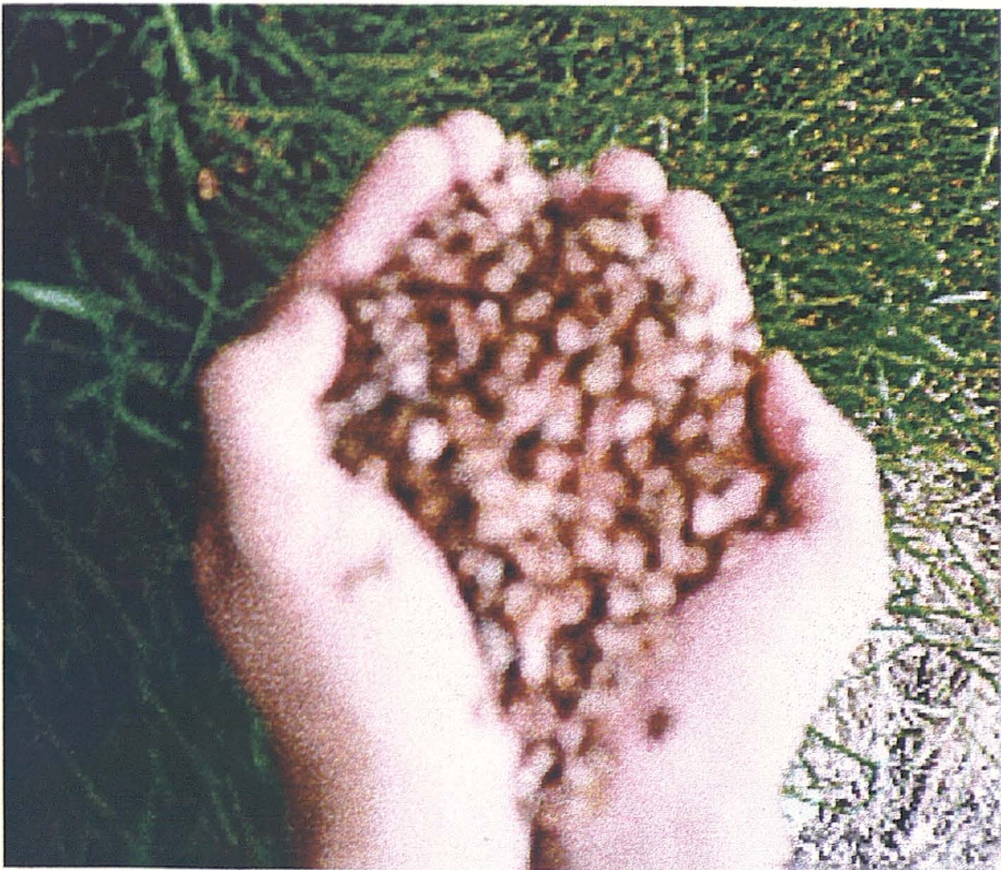
Fotografía n° 5: Relleno cerámico. Granulometría 5 a 7 mm
