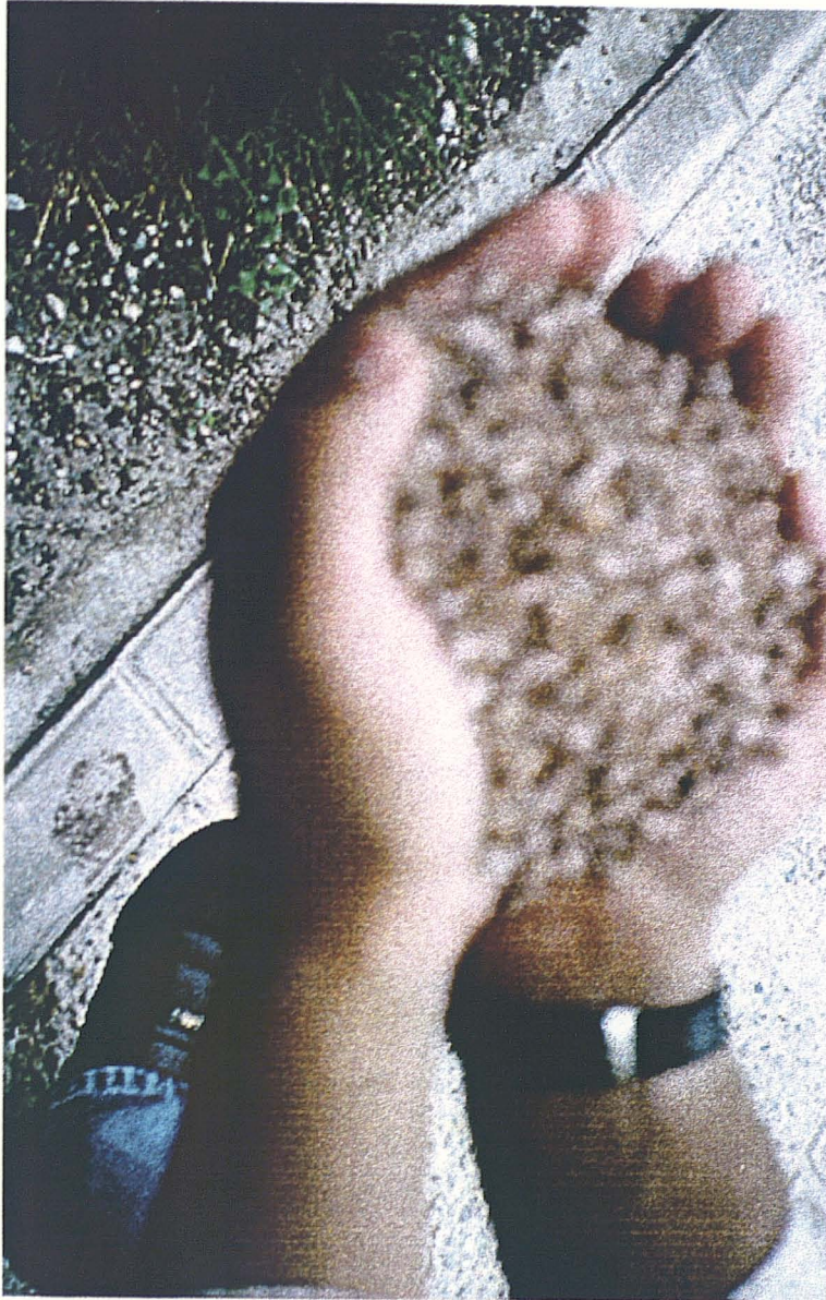
Fotografía n° 6: Relleno cerámico. Granulometría 2 a 5 mm. Sin impermeabilizar
