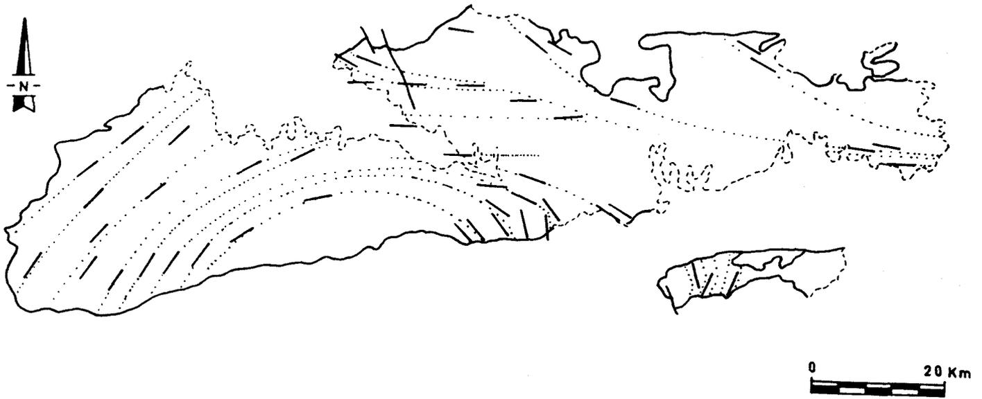
Fig. 3.21.- *Trayectorias de la dirección de máximo estiramiento durante formación de la fábrica planolinear construidas con los datos de la figura 3.19.*
