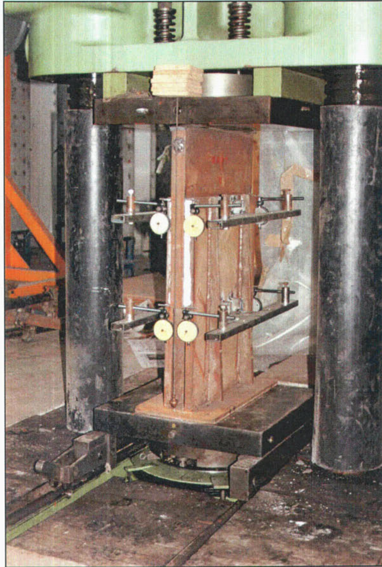
FOTO N°31: Probeta 7M situada en la prensa de compresión, con toda su instrumentación con flexímetros. Las soldaduras se encuentran pintadas con cal, habiéndose situado la banda de neopreno en el contacto entre la probeta y el plato fijo.
