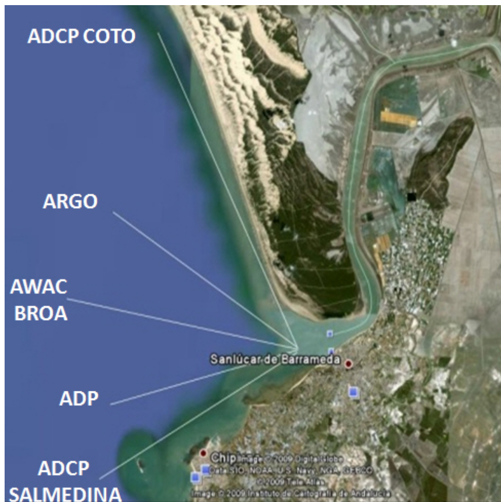
Figura 4.3: Instrumentación del Grupo de Dinámica de Flujos Ambientales en la desembocadura del Guadalquivir.
