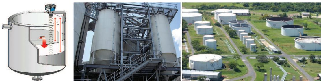
**Figura 8.4:** Aplicación del sistema TELIAMADE para determinar el nivel de llenado en tanques.
