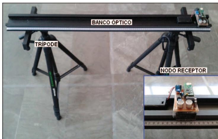
**Figura 7.2:** Banco óptico utilizado como soporte para colocar el nodo receptor en distintas posiciones.
