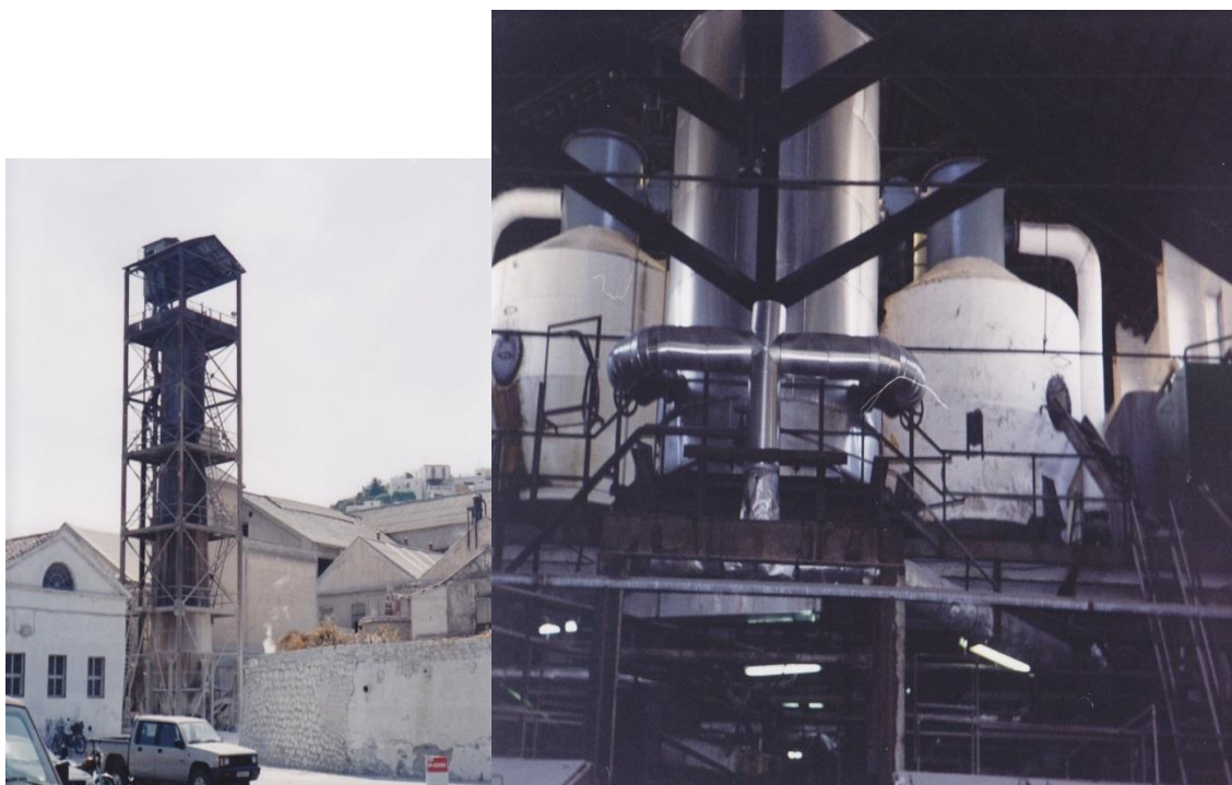
Figs. 501 y 502. Dos fotos de la calera (izquierda) y de las tachas (derecha) de azucarera de Guadalfeo (Salobreña)
