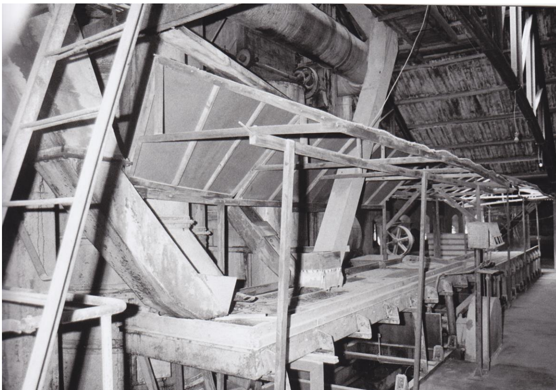
Fig. 9. Fotografía del secadero de azúcar de la fábrica Ntra. Sra. del Pilar (Motril). Fuente: SGAE. Benavente
