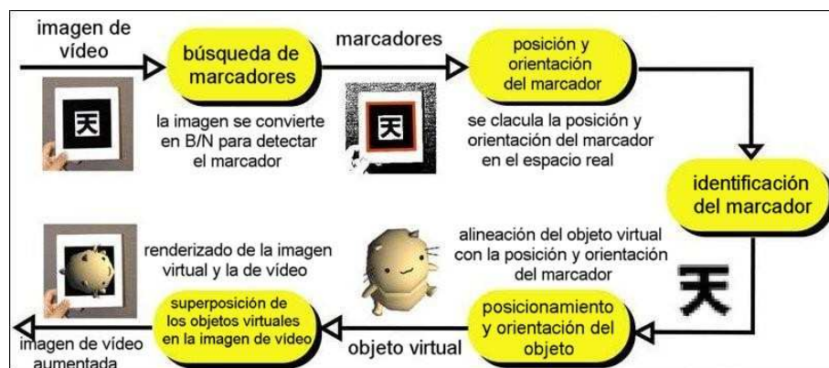
FIGURA 18. ESQUEMA DE FUNCIONAMIENTO DE UNA APLICACIÓN DE REALIDAD AUMENTADA UTILIZANDO LAS LIBRERÍAS ARTOOLKIT (KATO, 2000: 8).
