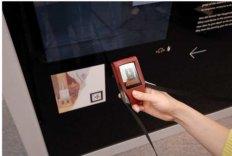
FIGURA 122. LOUVRE - DNP MUSEUM LAB. UTILIZACIÓN DE UNA DE LAS GUÍAS PERSONALES BASADAS EN REALIDAD AUMENTADA PARA EXPLORAR NUEVOS ENFOQUES SOBRE LAS OBRAS DE ARTE CONTENIDAS EN ESPACIOS EXPOSITIVOS. AQUÍ LA CÁMARA DEL DISPOSITIVO IDENTIFICA LA MARCA ASOCIADA AL PANEL APARECIENDO EL CONTENIDO VIRTUAL TRIDIMENSIONAL ASOCIADO (MUSEUMLAB.EU).
