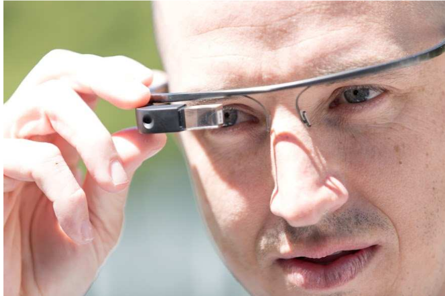
..... FIGURA 9. GOOGLE GLASS . PROTOTIPO DE HEAD MOUNTED DISPLAY CREADO POR GOOGLE X LAB EN EL QUE PUEDE APRECIARSE LA CÁMARA Y EL DISPLAY ( HTTP://WWW.INTELDIG.COM )
