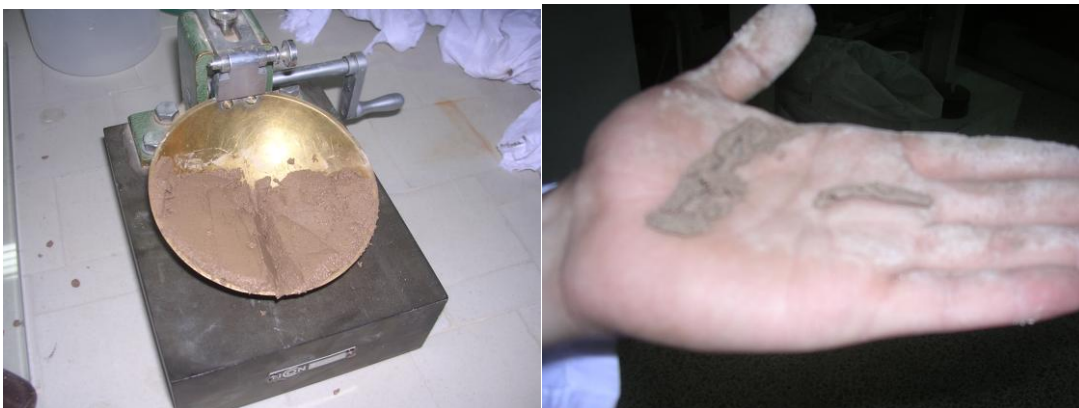
Figura 13. Ensayo de plasticidad según UNE 103103 y UNE 103104
