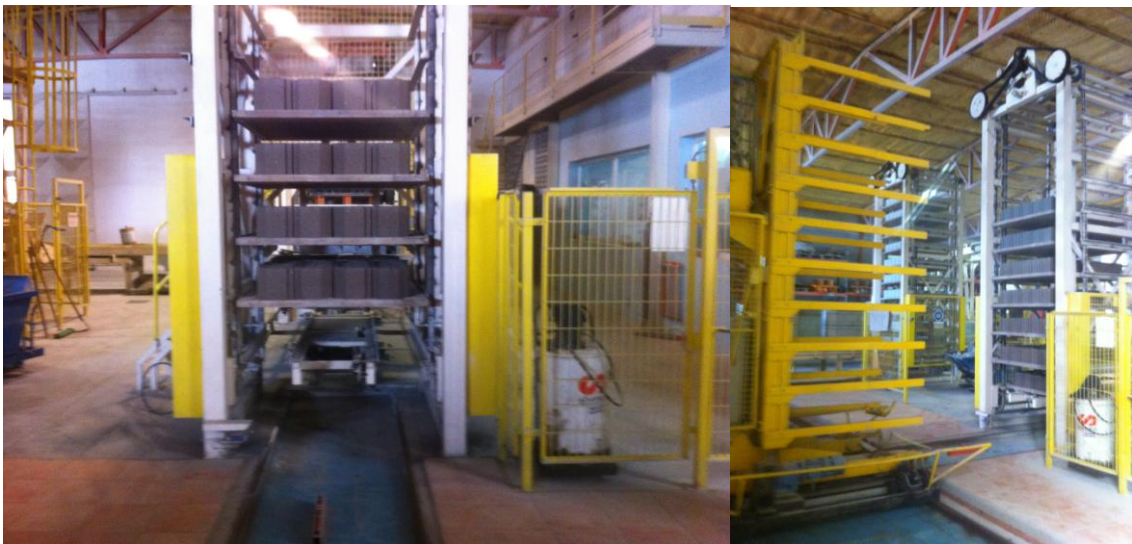
Figura 19. Carro contenedor vertical y traslado de tablas a la cámara de curado
