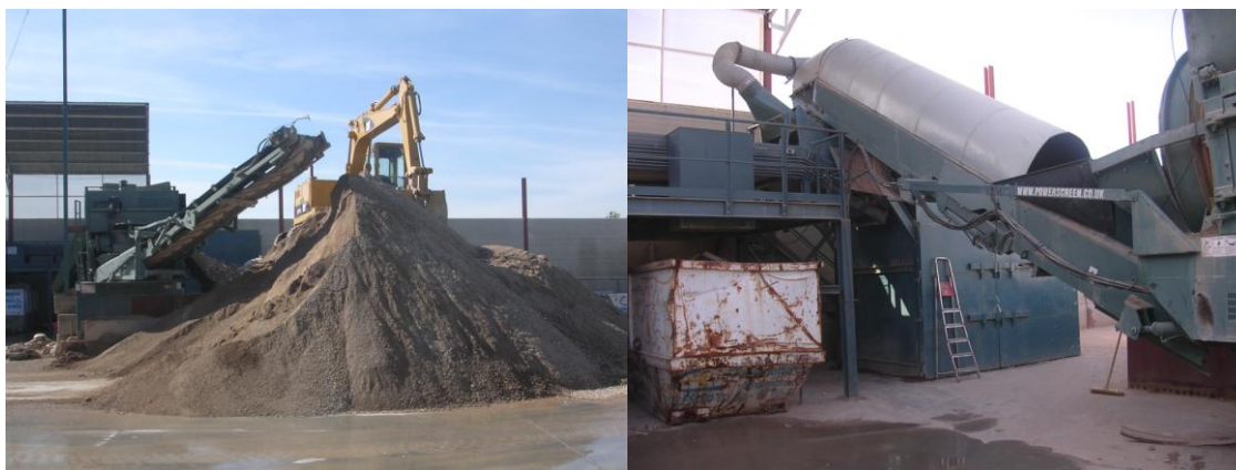
Figura 5. Separación del material de tamaño inferior a 10mm y salida hacia la cinta de triaje
