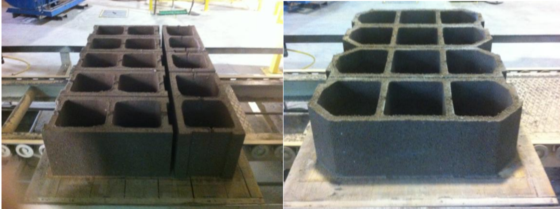
Figura 16. Bloques y bovedillas recién fabricadas
