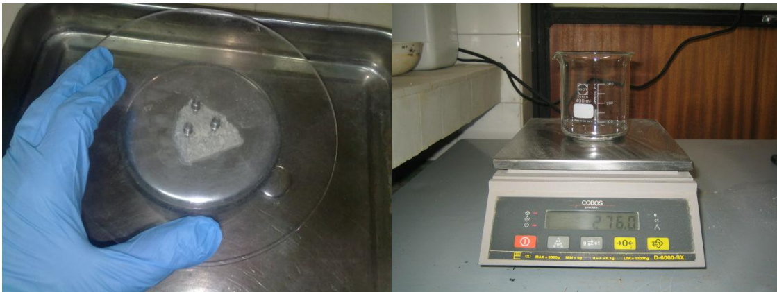
Figura 96. Medición de volumen por desplazamiento de mercurio descrito en la norma UNE 103108
