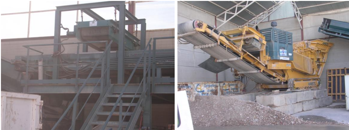
Figura 7. Separación de material férreo antes de la trituración y trituración, cribado y limpieza de metales férricos a la salida de la trituradora
