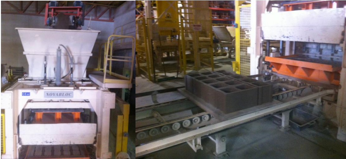
Figura 18. Equipo de vibrocompactación fabricando bloques
