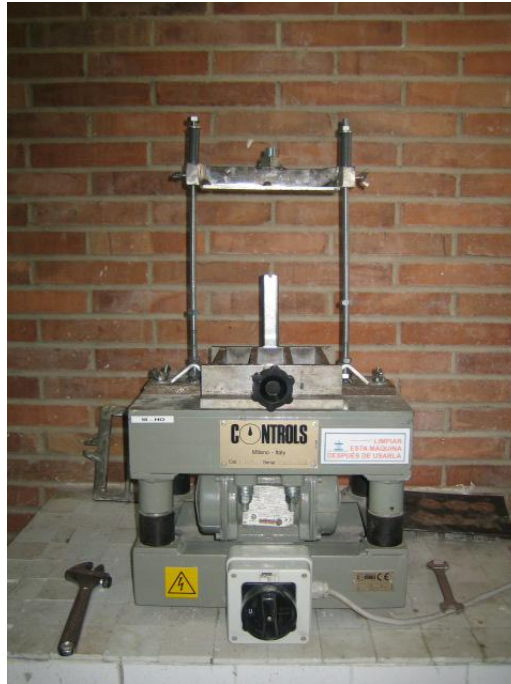
Figura 77. Equipo de compactación adaptado
