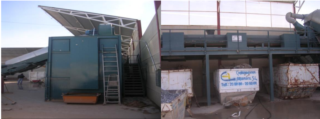
Figura 6. Aspiración de polvo y limpieza manual en cinta de triaje
