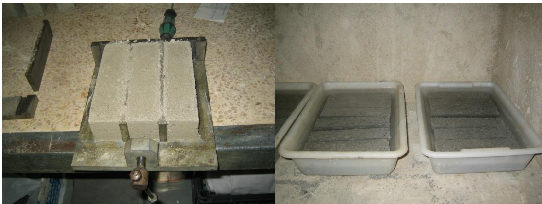
Figura 79. Desmoldeo y curado de probetas de mortero
