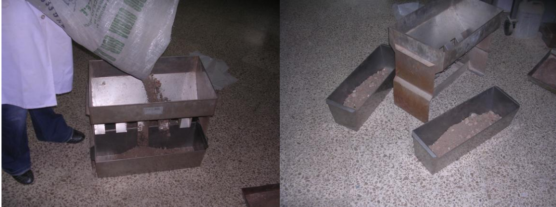
Figura 3. Procesado de las muestras por cuarteo según UNE-EN 932-2
