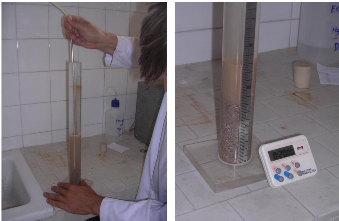
Figura 10. Ensayo de equivalente de arena según la norma UNE-EN 933-8
