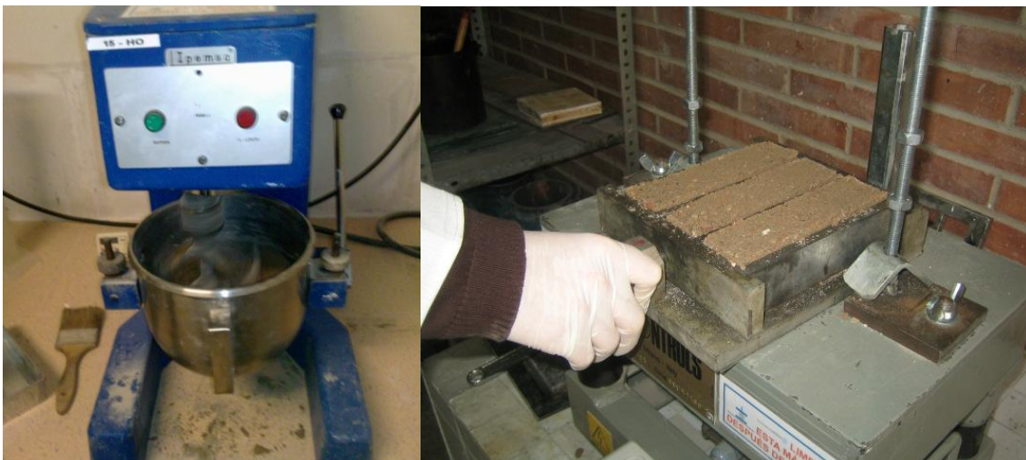
Figura 78. Fabricación de mortero y llenado de probetas
