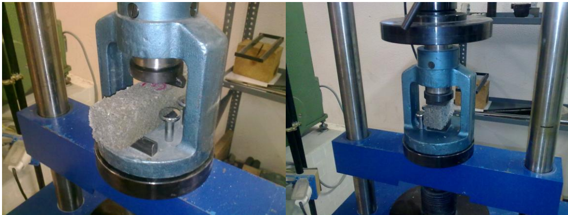
Figura 80. Rotura de probetas de mortero a flexión y compresión
