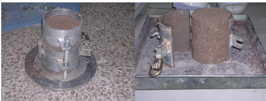
Figura 14. Ensayo próctor modificado según UNE 103501
