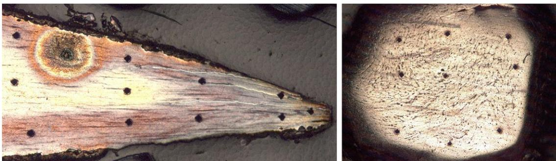
Fig. 3.9. Ejemplo de la disposición de las incisiones de microdureza en el filo de un puñal de base cobre y en un remache de plata.
