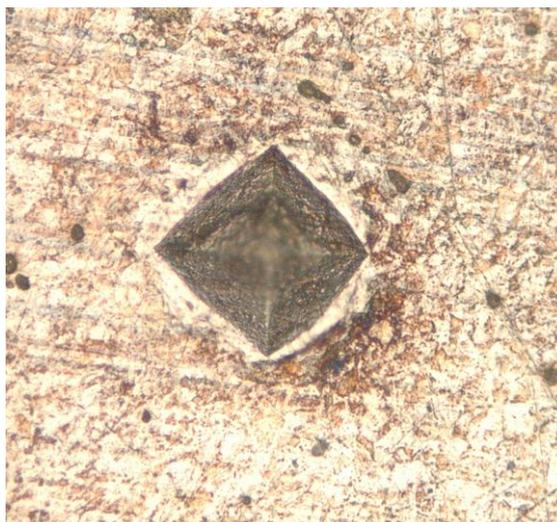
Fig. 3.8. Ejemplo de una marca dejada por el microdurómetro en la superficie de una muestra de plata.
