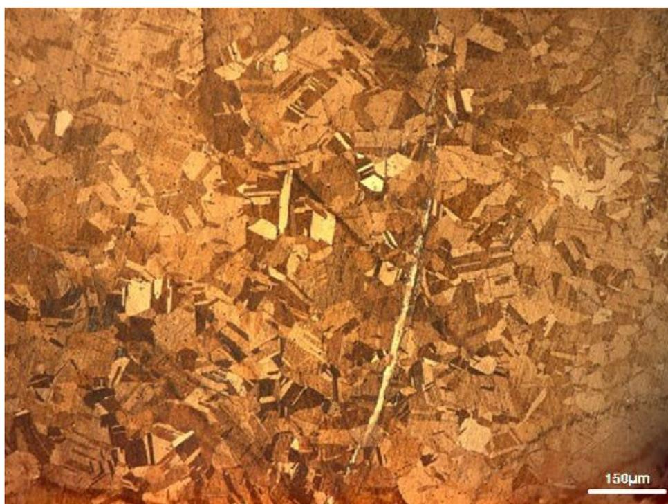
Fig. 5.31. Sección metalográfica del Brazaletes DJ 00760 del Cerro de la Encina. X100. Estructura de Forja y Recocido.
