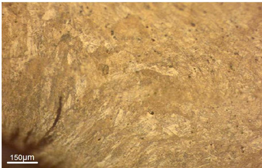
Fig. 5.44 Detalle de la microestructura anterior. X100. Obsérvese la severa deformación de los granos tras una última fase de forja.
