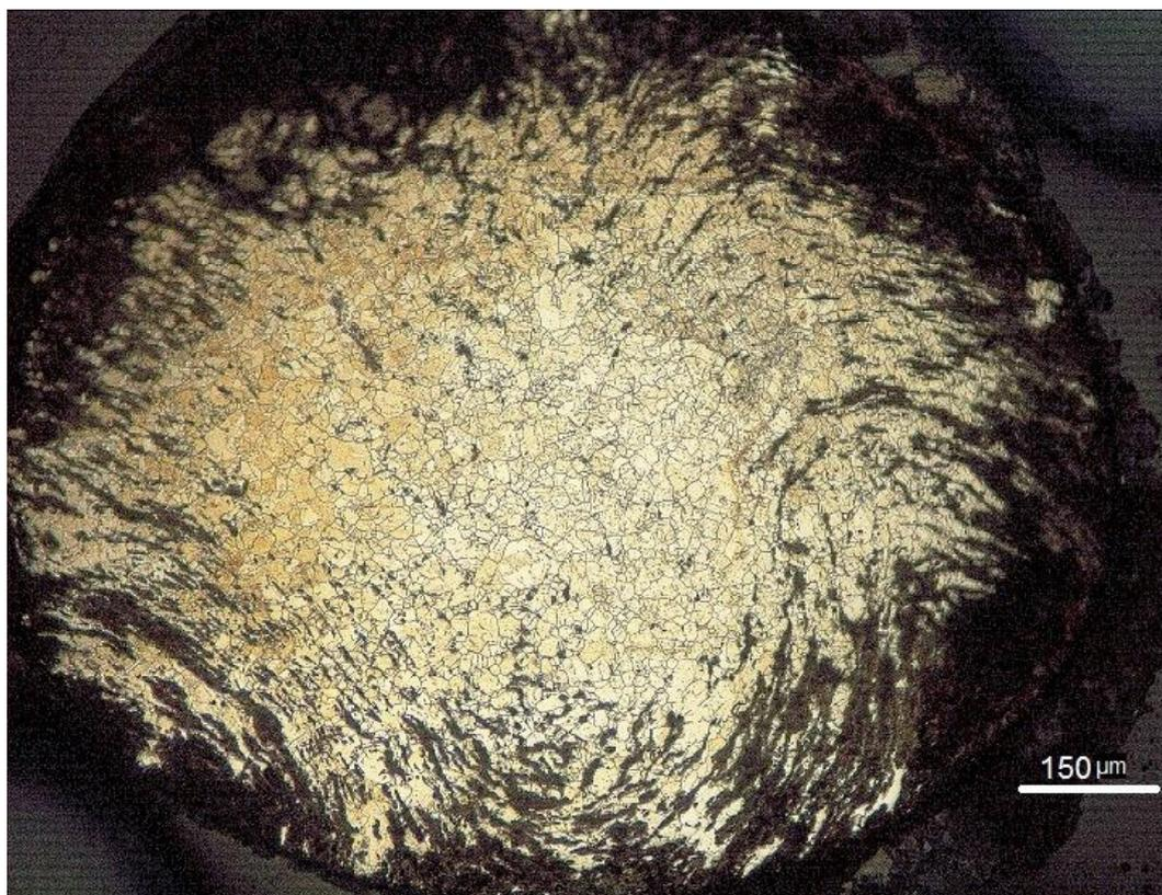
Fig. 5.26. Sección metalográfica del anillo del Pantano de los Bermejales. X100. Nótese las bandas de corrosión selectiva en los bordes del anillo.
