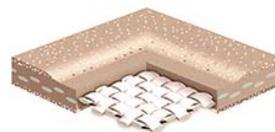
Fig. 1: Estructura de la fibra de vidrio recubierta de PTFE
