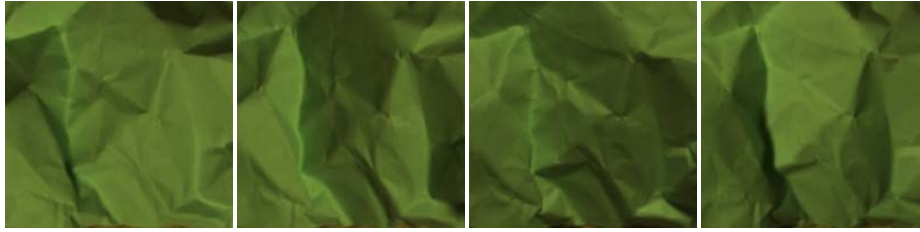
Figura 2.3: Distintas capturas de un mismo objeto manteniendo fija la posición de la cámara y variando la dirección de iluminación
