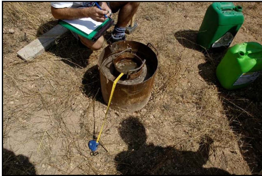
Figura 7. Medición de la tasa de infiltración usando el método del doble anillo de Muntz.
