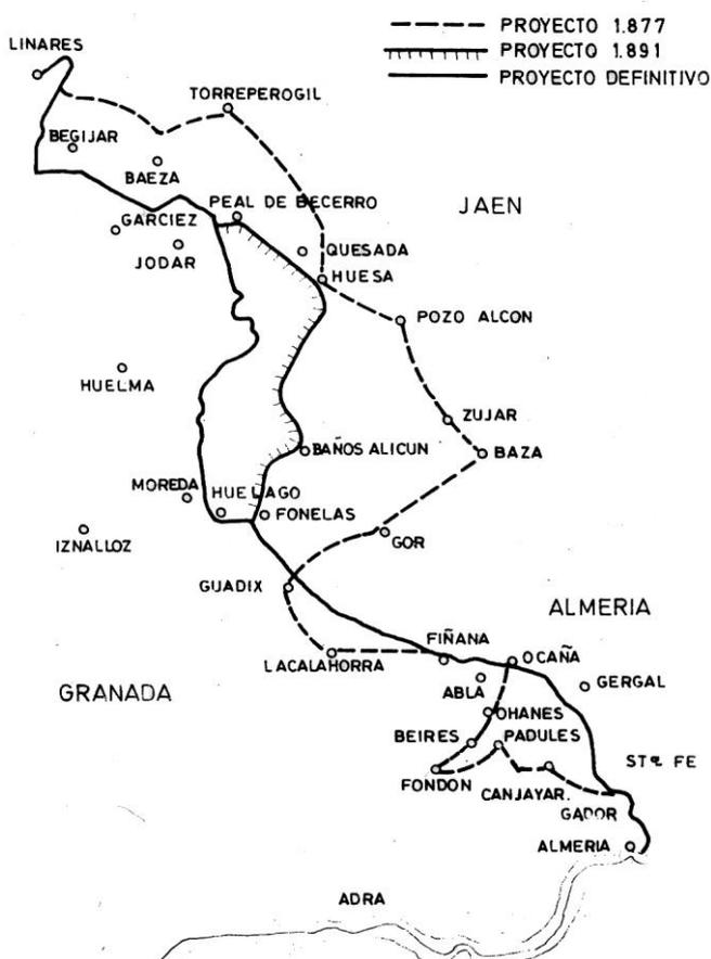
Trazados del ferrocarril Linares-Almería según los distintos proyectos.
