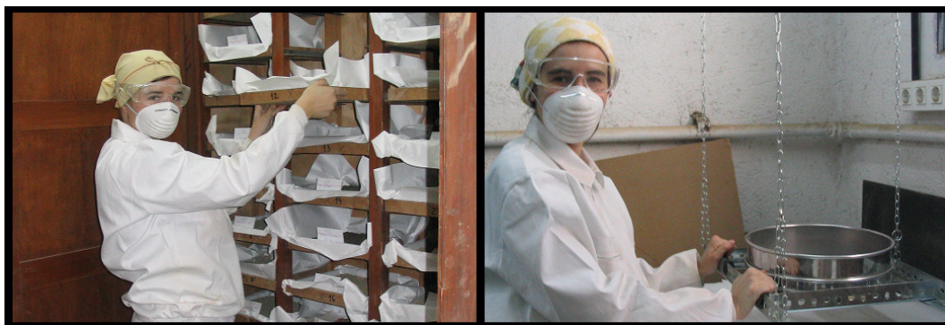
Figura 2.46: Fotografía de la preparación de las muestras de suelos de la Vega de Granada (estufa de secado y tamiz de suelos).
