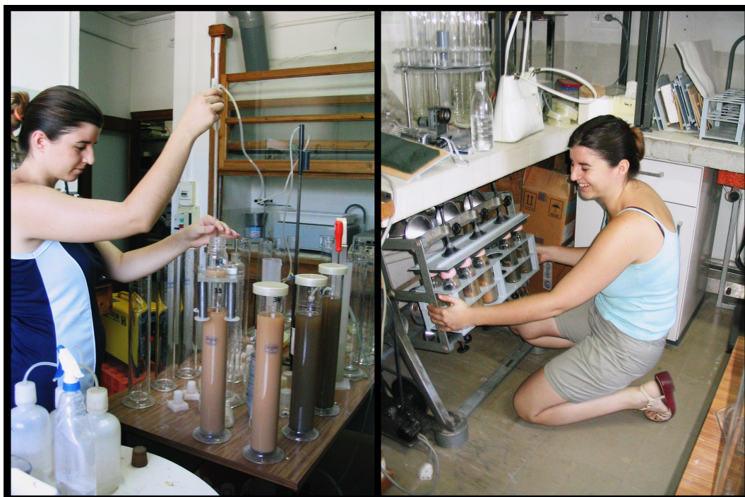
Figura 2.47: Fotografía de los análisis de las muestras en la Estación Experimental del Zaidín. Determinación de las arcillas y batidora de las muestras.
