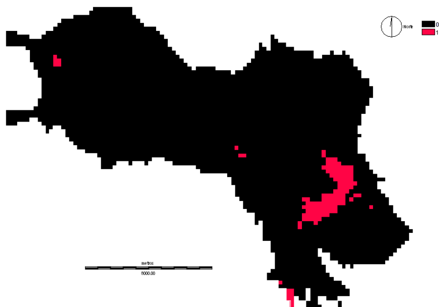
Figura 5.5: Mapa binario resultado de la superposición de zonas aptas (1) y no aptas (0) de calidad del agua subterránea según RD 140/2003 mediante criterios de probabilidad.
