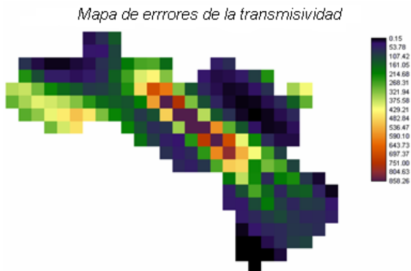
Figura 3.9: Mapa de errores de la estimación por krigeaje de la variable transmisividad.
